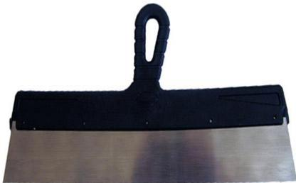
Для удаления со стен старого поверхностного слоя пользуются широким шпателем. Для нанесения шпаклевки воспользуйтесь узким шпателем.
