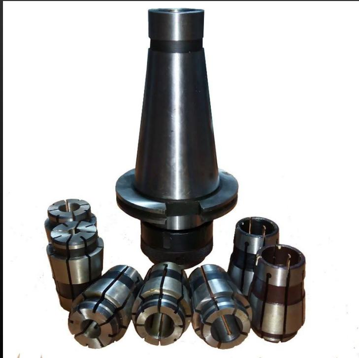
В первую очередь рассмотрим крепление инструмента в цанговом патроне, который предназначен для крепления концевых фрез с цилиндрическим хвостовиком.
