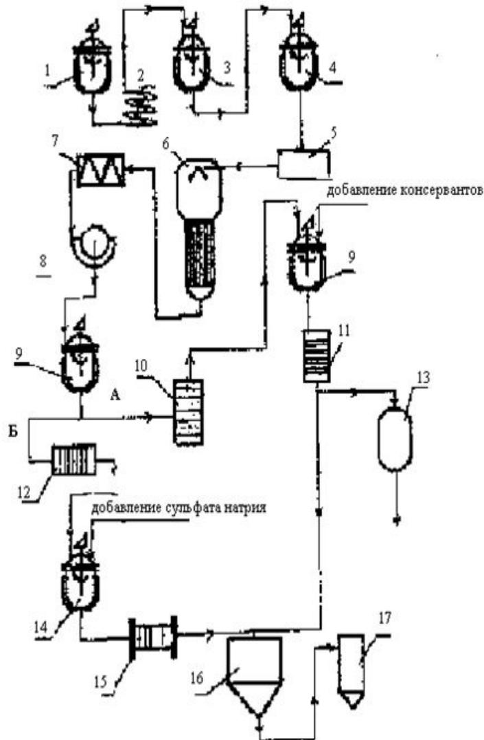
**Рис. 1. Примерная технологическая схема получения аминокислоты:**
