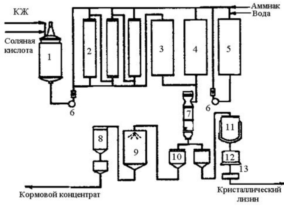
Рис. 2. Технологическая схема получения лизина:
