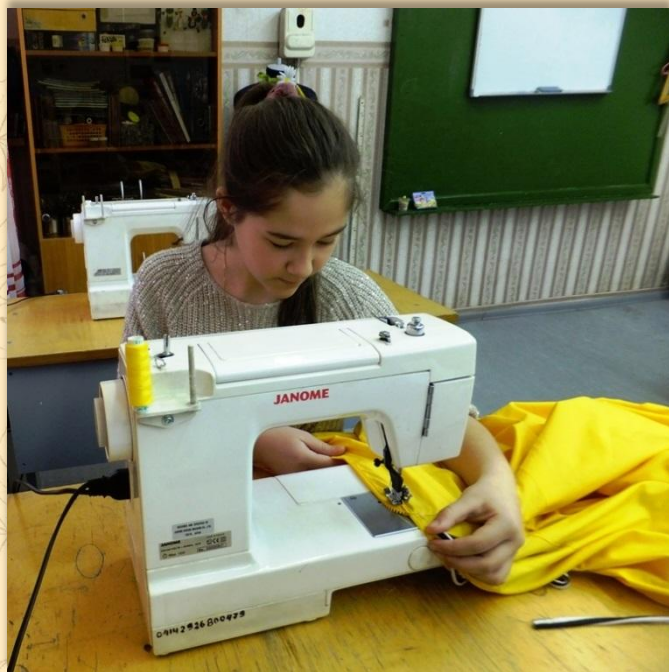
Краевой обтачной шов на ребро
