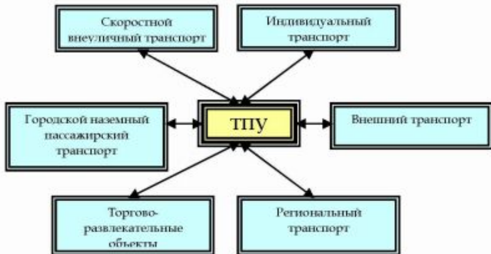
Рис. 5.6 Принципиальная схема современного транспортно-пересадочного узла
