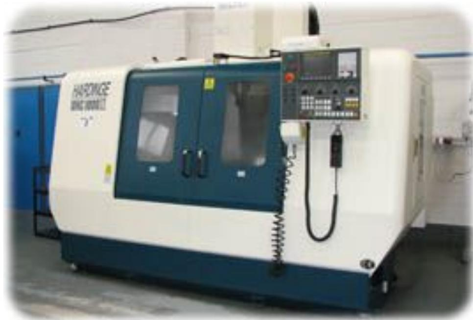
***Система числового программного управления (СЧПУ)*** представляет совокупность функционально взаимосвязанных и взаимодействующих технических и программных средств, обеспечивающих числовое программное управление станком.
