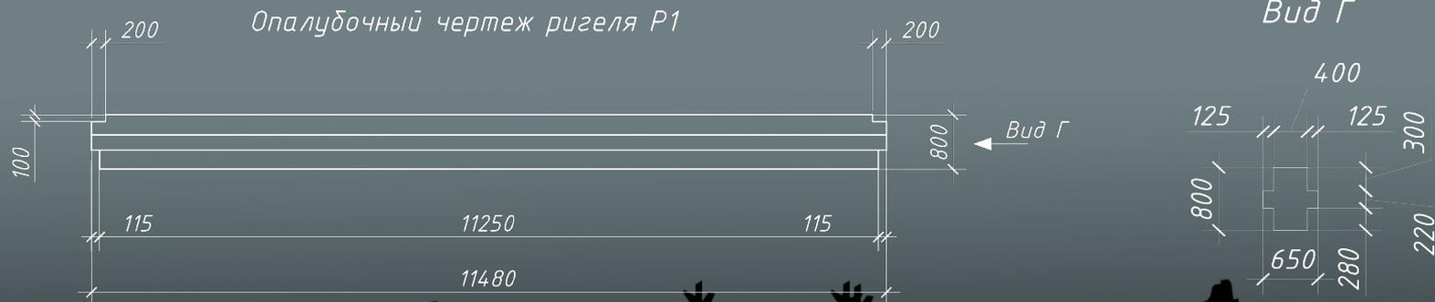
Произвели расчет крестообразного железобетонного 12 метрового ригеля по первому и второму предельному состоянию, а также на образование трещин и их раскрытию.
