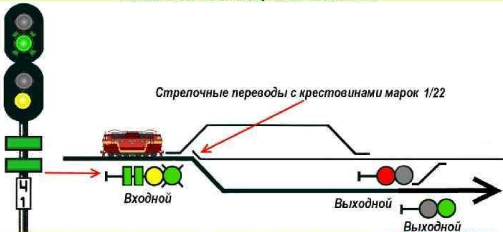
Разрешается поезду следовать на станцию со скоростью - **не более 120 км/ч** на боковой путь; следующий светофор (маршрутный или выходной) открыт и требует проследования его с установленной скоростью
