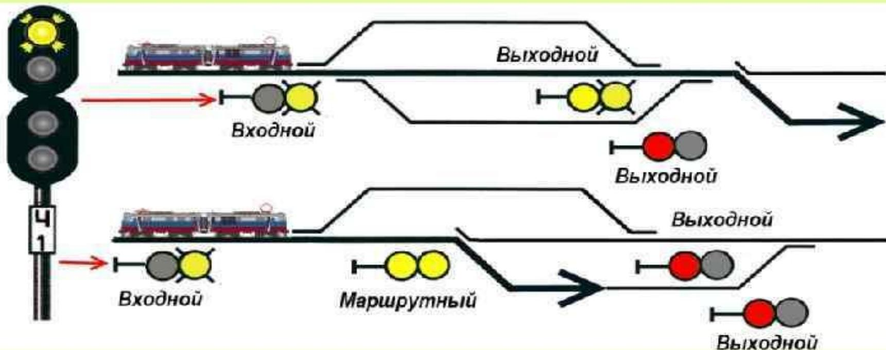
Разрешается поезду следовать на станцию по главному пути - с установленной скоростью; следующий светофор (маршрутный или выходной) открыт и требует проследования его с уменьшенной скоростью
