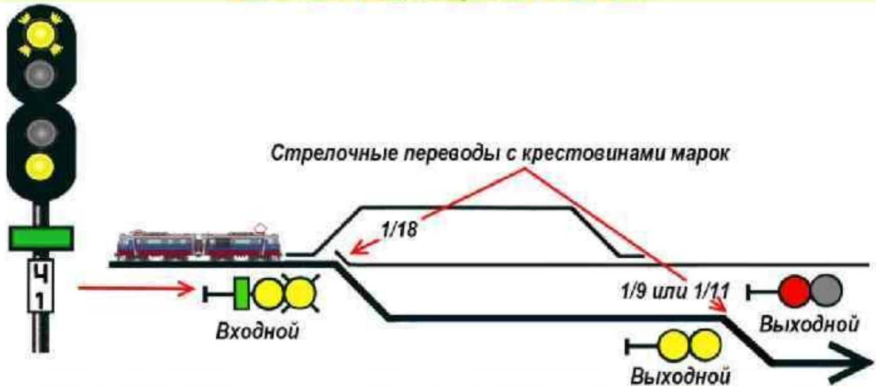
Разрешается поезду следовать на станцию со скоростью - **не более 80 км/ч** на боковой путь; следующий светофор (маршрутный или выходной) открыт и требует проследования его с уменьшенной скоростью
