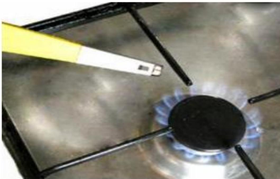
При механической деформации некоторых кристаллов (например, кварца) происходит перемещение электронов из одной области кристалла в другую
