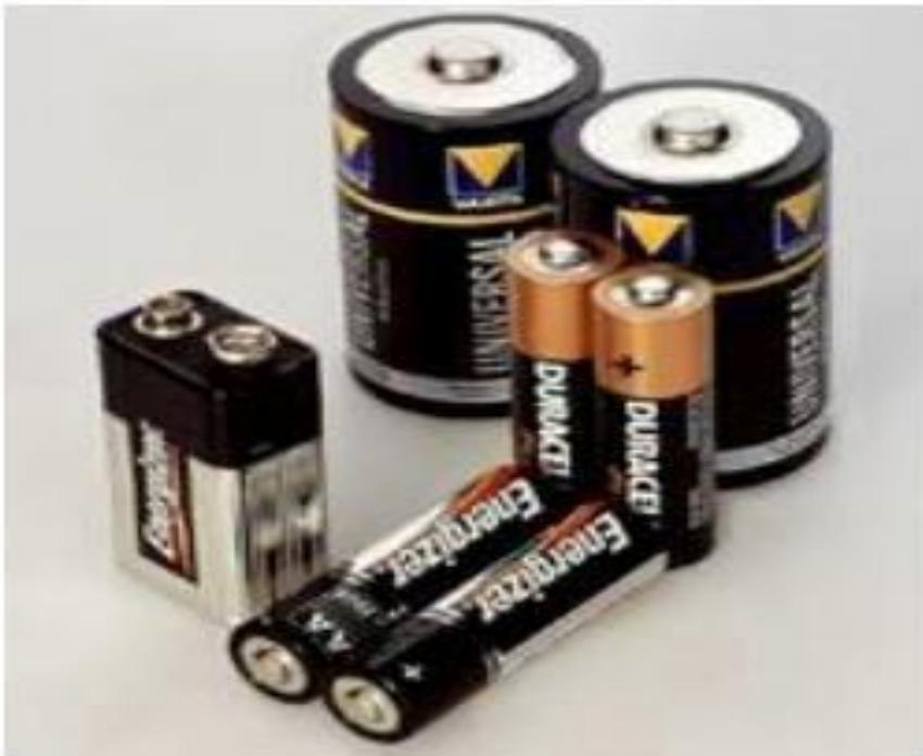
Два разных материала погружаются в раствор или другую проводящую среду. За счет необратимых химических реакций, идущих на границе «раствор – твердое тело», происходит накопление электронов или заряженных ионов на электродах. В гальванических элементах происходит необратимое превращение энергии химических связей, накопленной при синтезе этих веществ, в энергию разделенных зарядов
