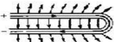
Линии внешнего стационарного электрического поля направлены под углом к поверхности проводника с током, а линии внутри проводника всегда параллельны его поверхности
