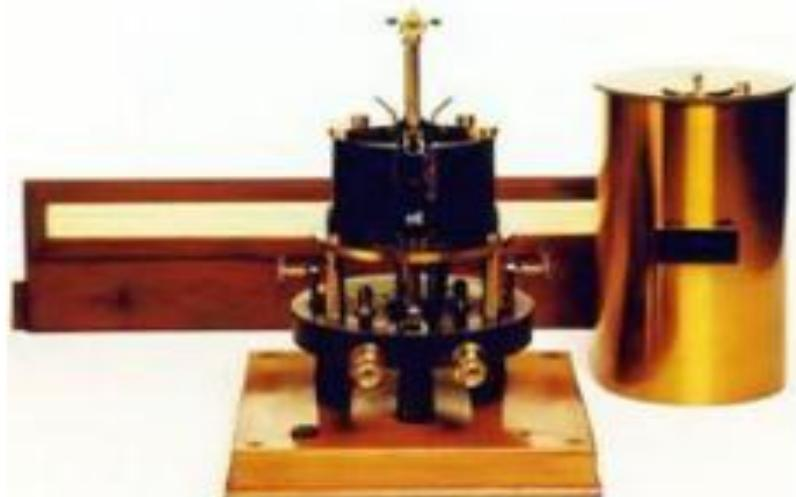
При нагреве спая двух разных металлов происходит перемещение электронов из одного металла в другой. Таким образом, тепловая энергия преобразуется непосредственно в энергию разделенных зарядов.
