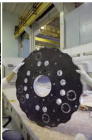
Зона для изготовления сотопанелей из алюминия и композитных обшивок
