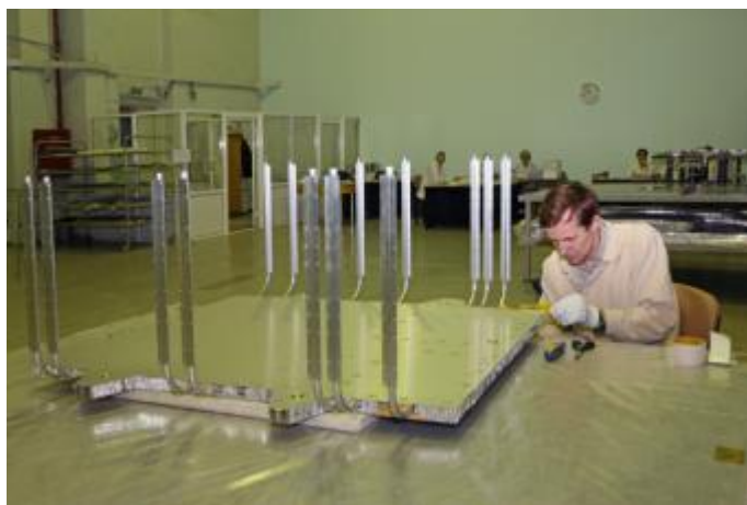
Зона для изготовления сотопанелей из алюминия и композитных обшивок
