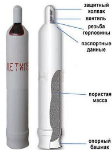
Схема ацетиленового баллона в разрезе
