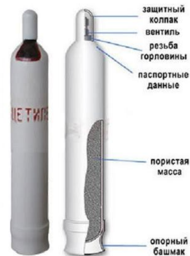
Схема ацетиленового баллона в разрезе
