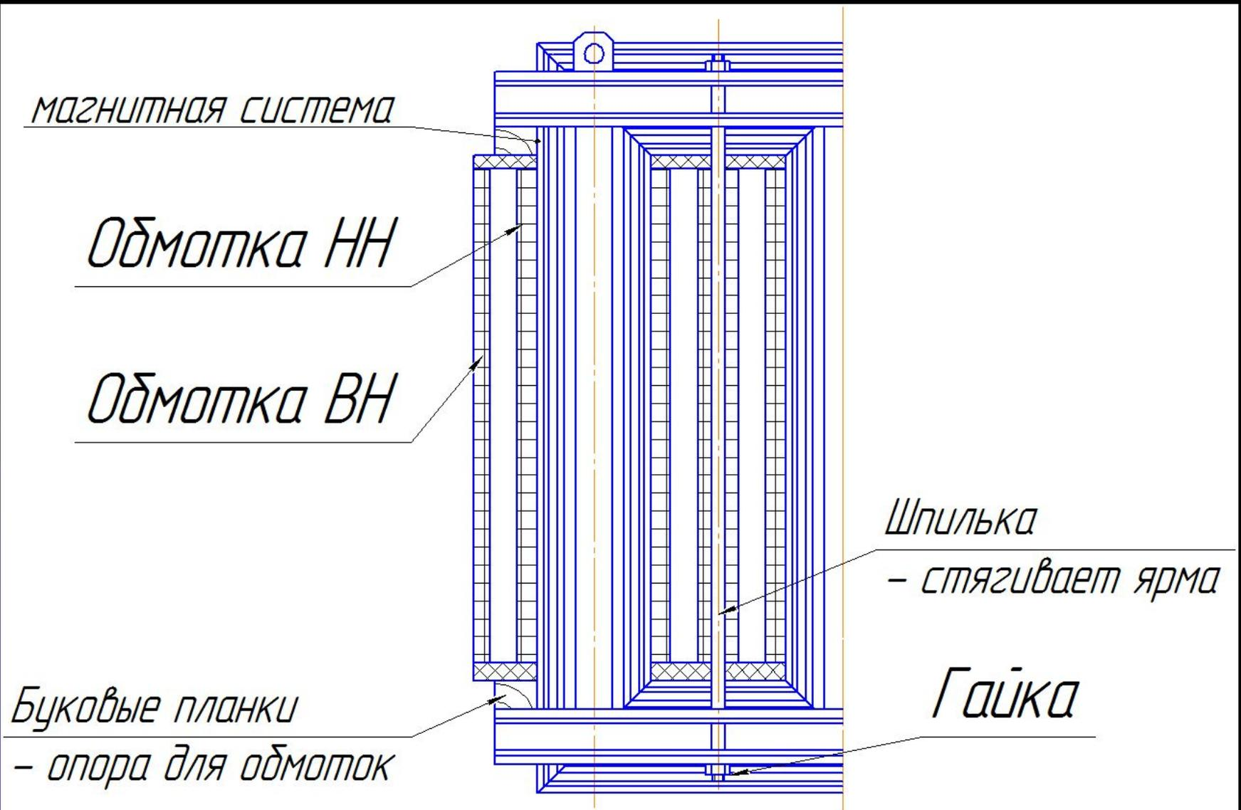
4. Помещаем магнитную систему с обмотками в бак, сверху рисуем крышку, на крышке устанавливаем изоляторы, рисуем соединение обмоток с изоляторами и регулятором напряжения.
