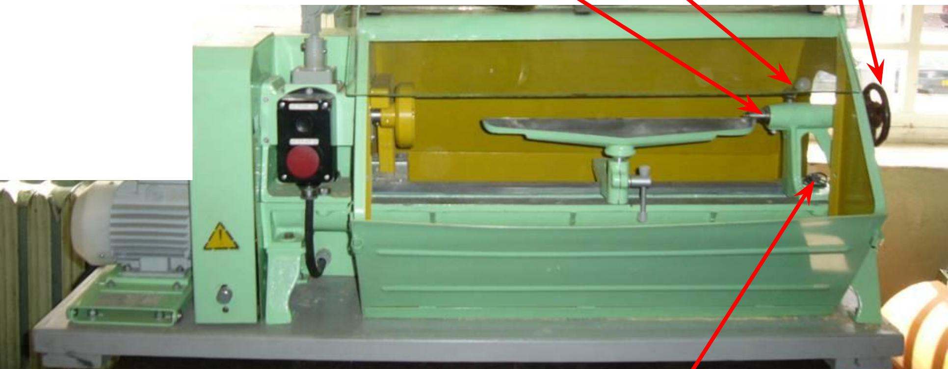
*Гайка фиксатор задней бабки*
