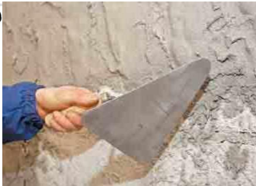
Штукатурная кельма – для нанесения раствора при оштукатуривании, очистки инструментов, дозирования при приготовлении раствора
