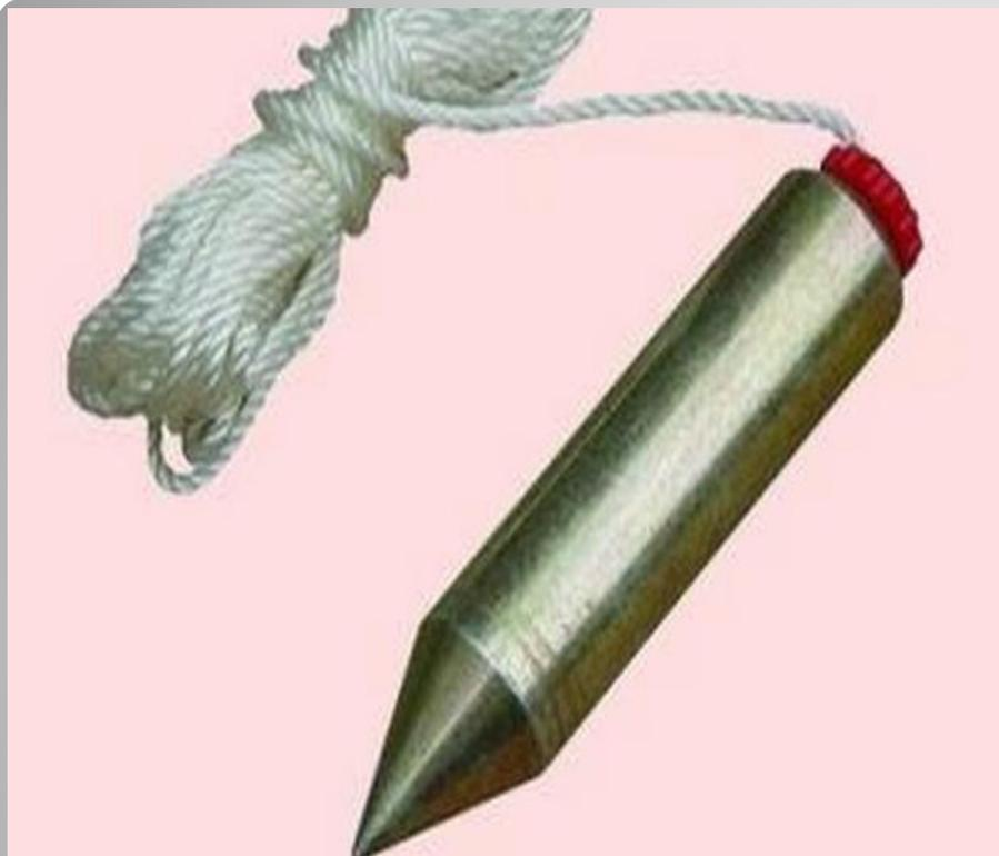
**Отвес – для провешивания
