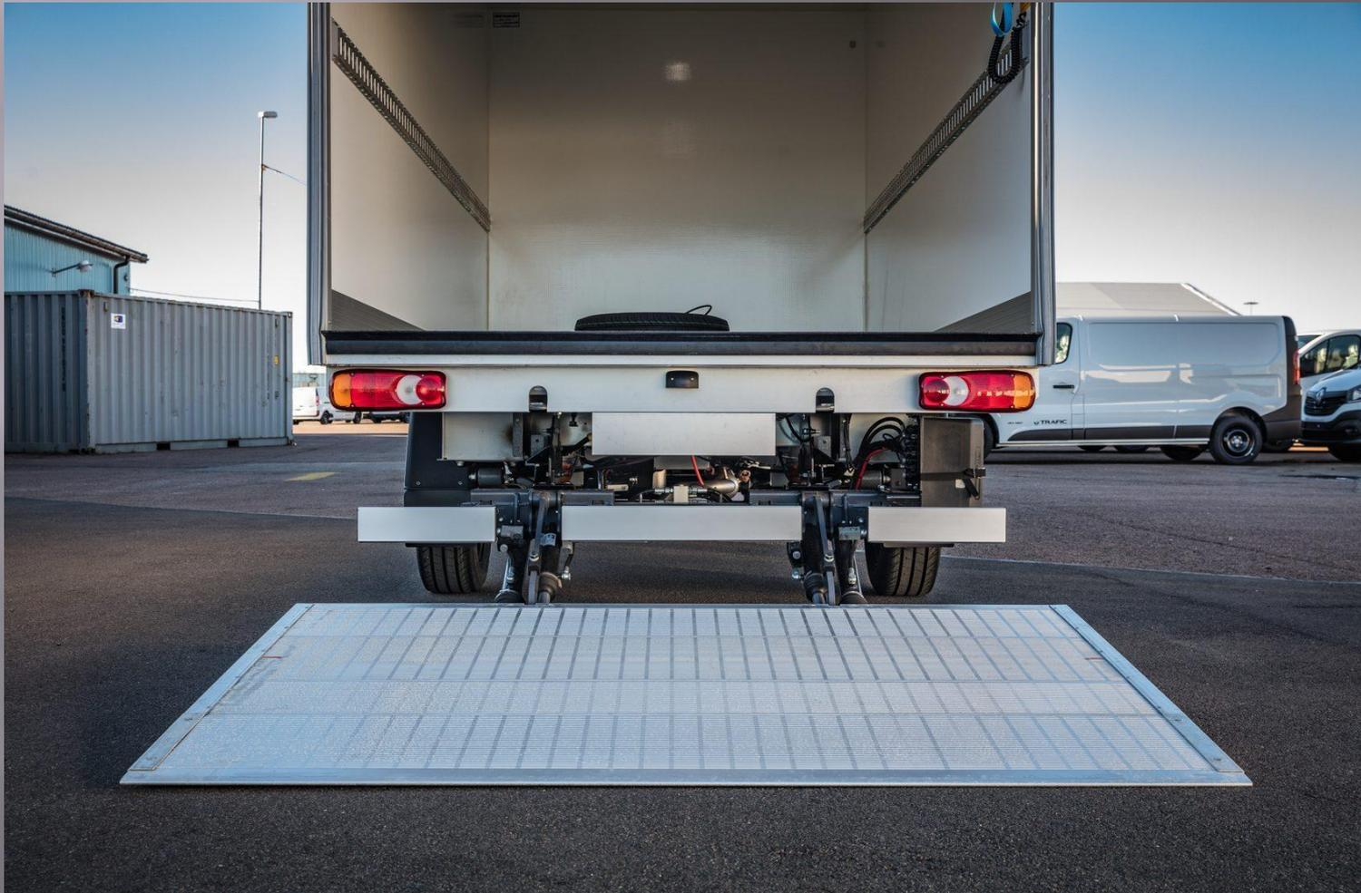
В тех случаях, когда кузов автомобиля не имеет бортов, грузоподъемный борт выполняется в виде съемной горизонтальной площадки, размеры которой несколько меньше борта кузова автомобиля.
