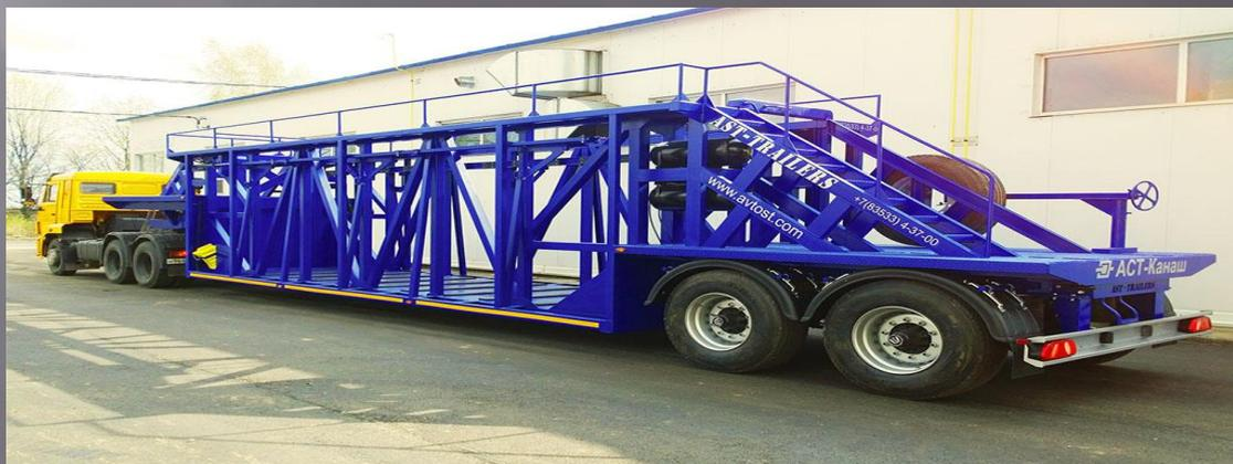
**Фермовозы** предназначены для перевозки ферм большой длины.
