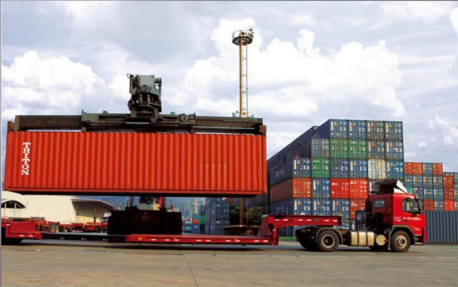
Для перевозки большегрузных контейнеров полуприцепы-контейнеровозы имеют специальные поворотные устройства (замки) для фиксации контейнеров на грузовой платформе. Они могут быть оборудованы гидравлическими погрузочно-разгрузочными устройствами.
