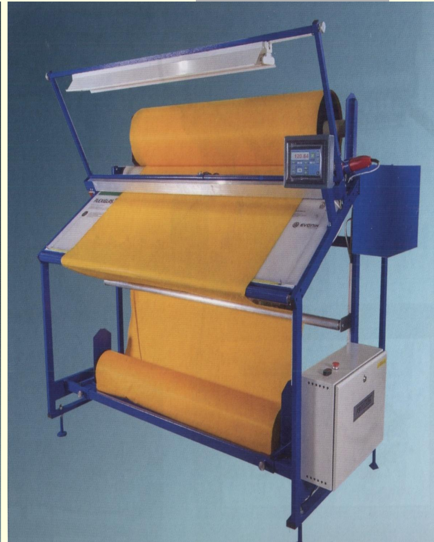
Мерильно- браковочная машина модели A02.5
