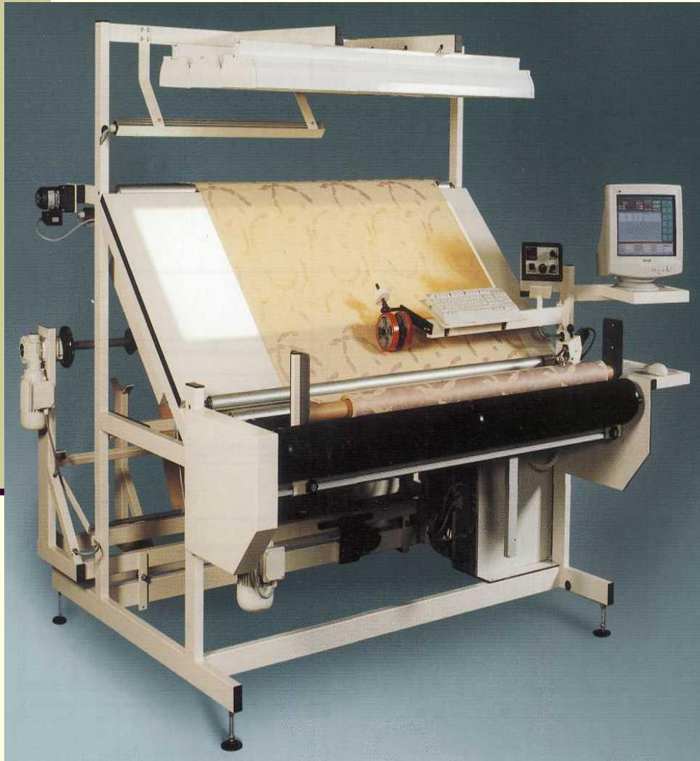
Браковочно-промерочная машина NS – 58 , фирмы AB Calator (Германия)
