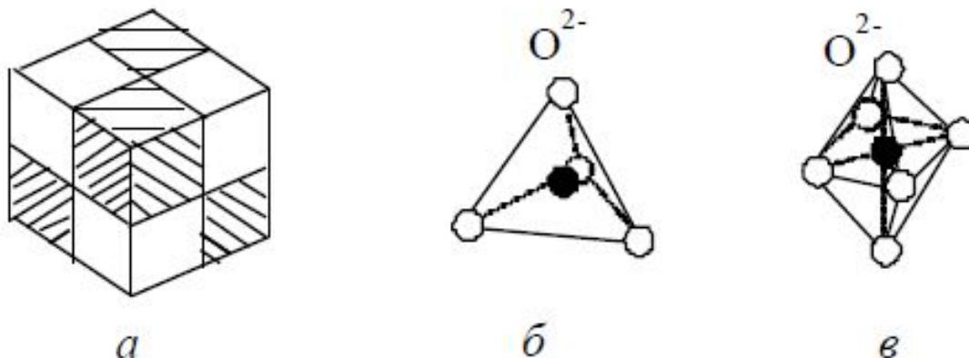
Рисунок 3. Структура феррошпинели: *а* - элементарная ячейка; *б* - тетраэдрическое междоузлие (тип *A*); *в* - октаэдрическое междоузлие (тип *B*)
