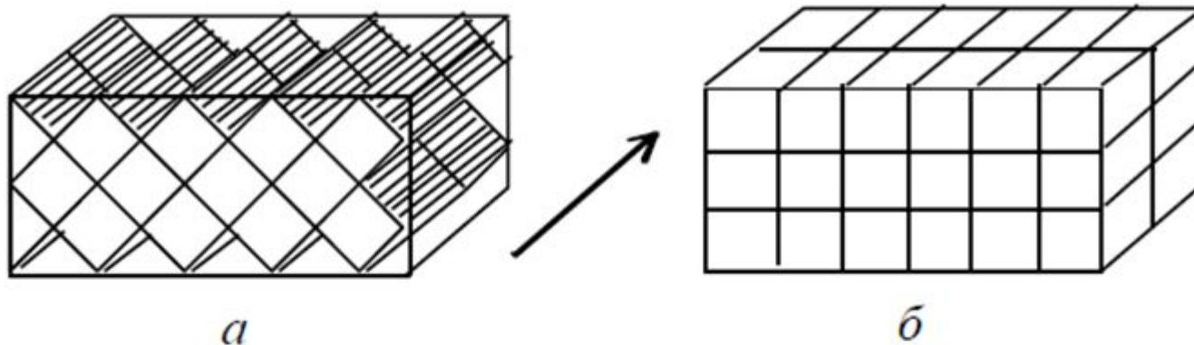
Рисунок 2. Условное изображение текстур электротехнической стали: *а* - ребровая текстура; *б* - кубическая текстура
