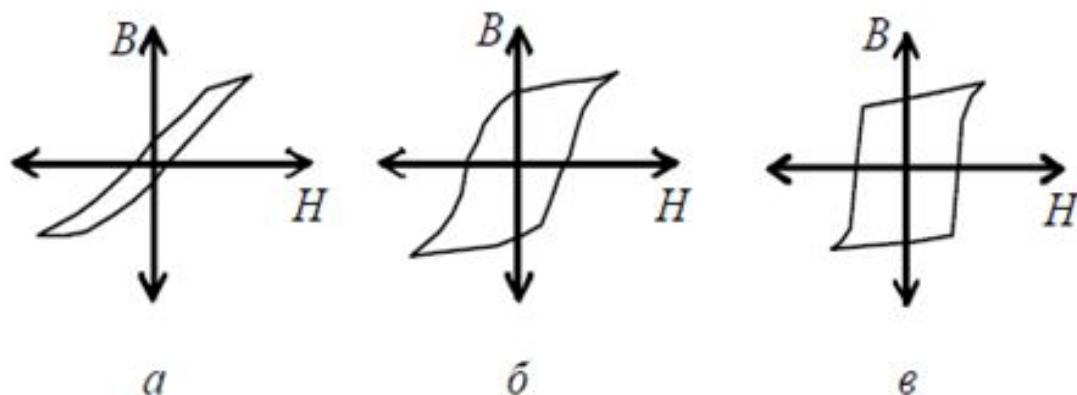
Рисунок 1. Предельные петли гистерезиса различных материалов: *а* - магнитомягкие материалы; *б* - магнитотвёрдые материалы; *в* - материалы с ППГ
