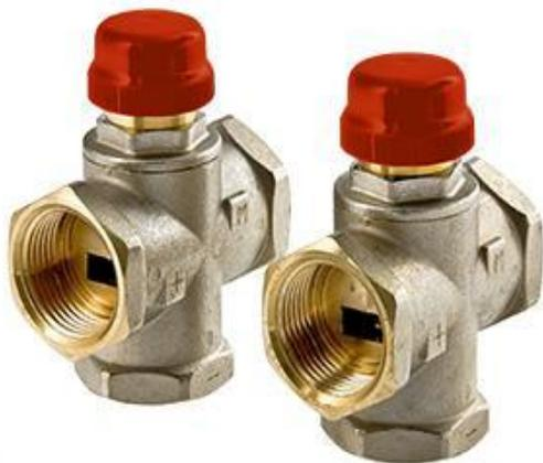
**MR 01** – клапан с боковым смещением для установки на байпасе. Полное перекрытие байпаса невозможно, что позволяет избежать установки перепускного клапана. Повышенная пропускная способность;
