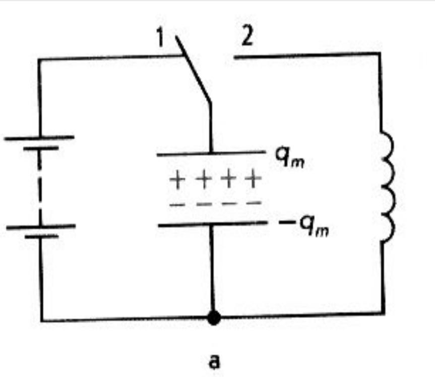
Соединим конденсатор с источником тока, поставив переключатель в положение 1. Конденсатор зарядится, на его пластинах появится электрический заряд: на одной  $+$ , на другой  $-$ .
