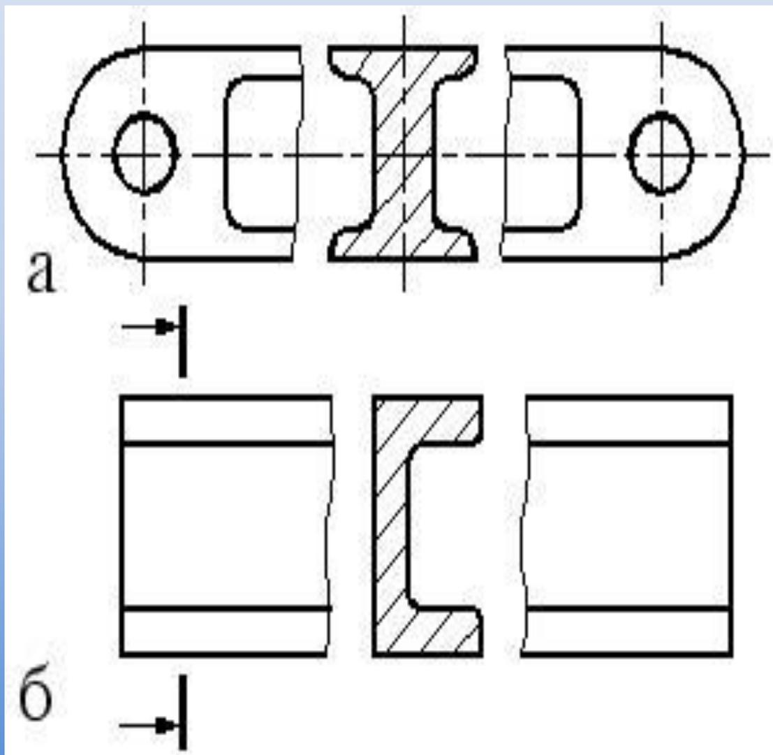
*Если сечение находится в разрыве между частями одного и того же вида, то его выполняют сплошной основной линией.*
