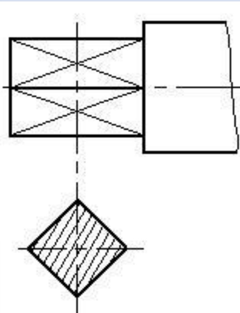
*Сечения с линией контура под углом  $45^\circ$  штрихуются под углом  $30^\circ$  или  $60^\circ$*
