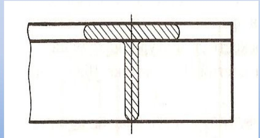
По расположению на чертеже сечения разделяются на **вынесенные** и **наложенные**.
