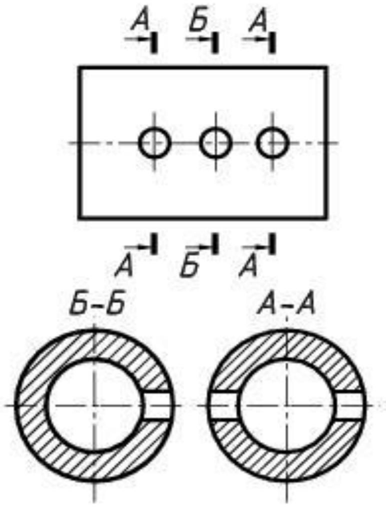
*Для нескольких одинаковых сечений, относящихся к одному предмету, линию сечения обозначают одинаковыми буквами и вычерчивают одно сечение*
