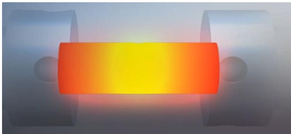
Рис. 3 Распределение температурного поля вдоль графитовой печи
