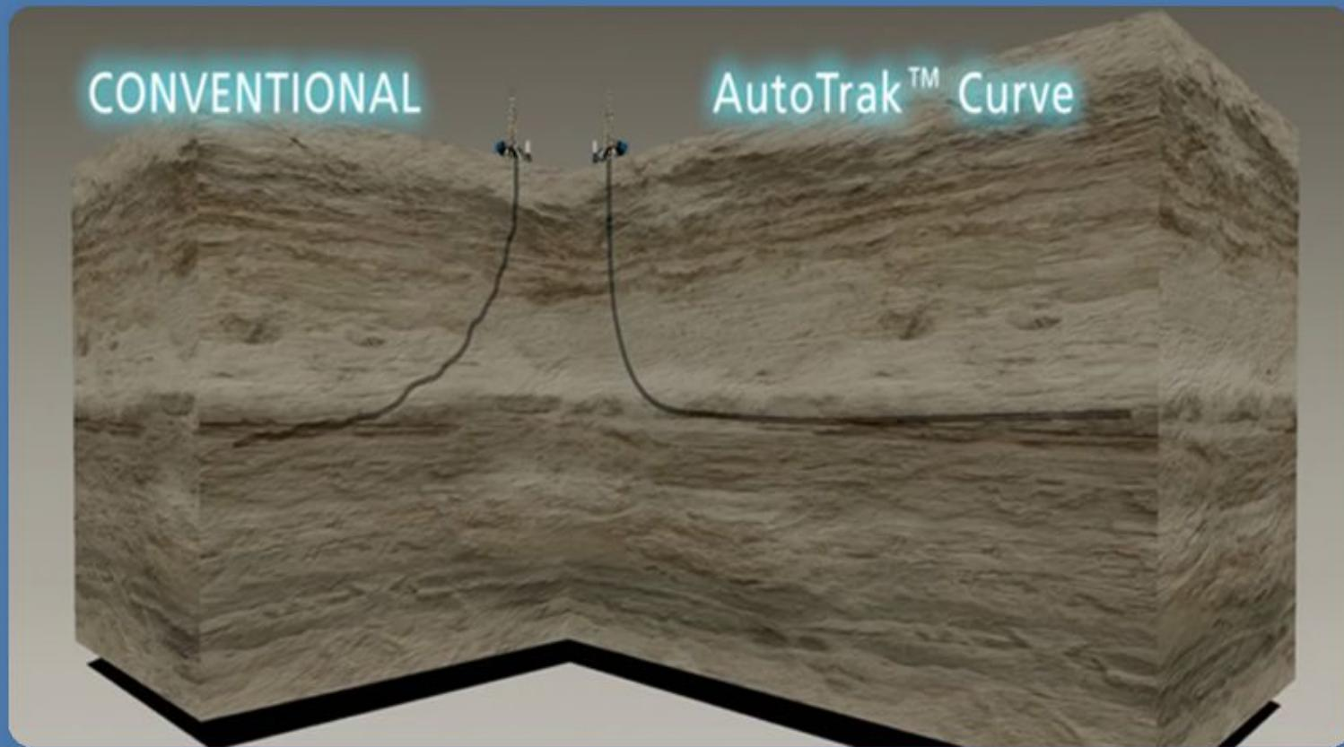
Сравнение между обычной роторной системой и AutoTrak
