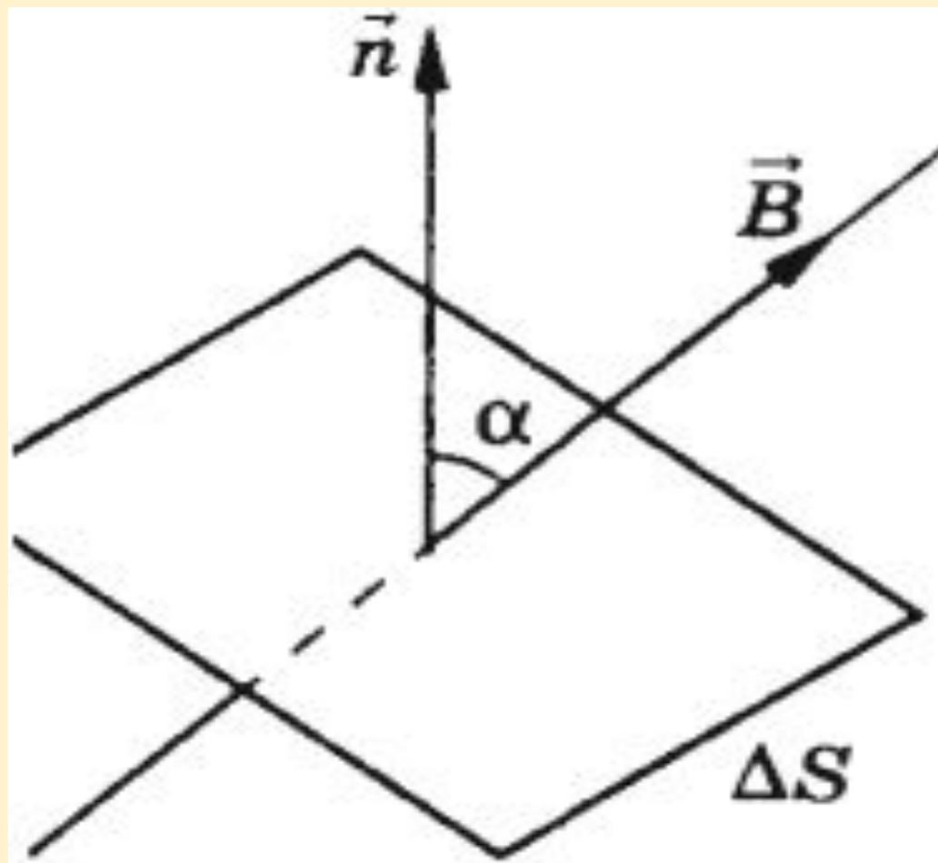
Магнитный поток в 1 вебер создается однородным магнитным полем с индукцией 1 Тл через поверхность площадью 1 м<sup>2</sup>, расположенную перпендикулярно вектору магнитной индукции:
