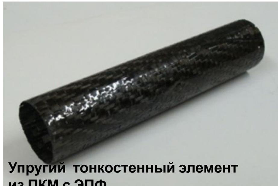
Упругий тонкостенный элемент из ПКМ с ЭПФ
