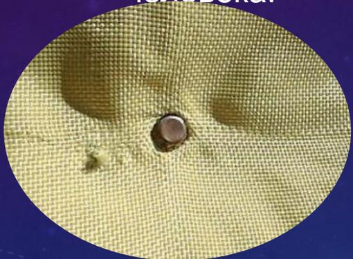
Пуленепробиваемая ткань, армированная углеродными нанотрубоками и арамидными нановолокнами
