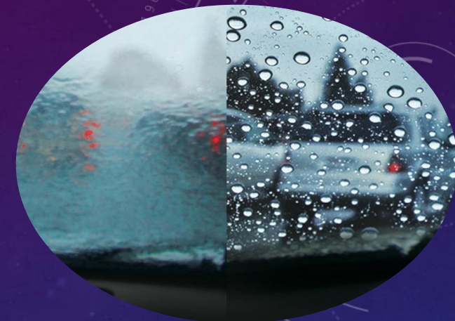
Гидрофобные покрытия для стекол на основе наночастиц диоксида кремния
