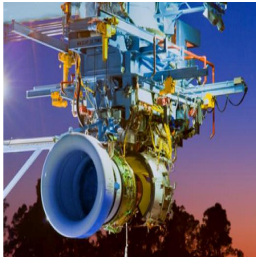
Наземные испытания двигателя PW PW1524G, в котором использованы детали, изготовленные PIM и AM методами
