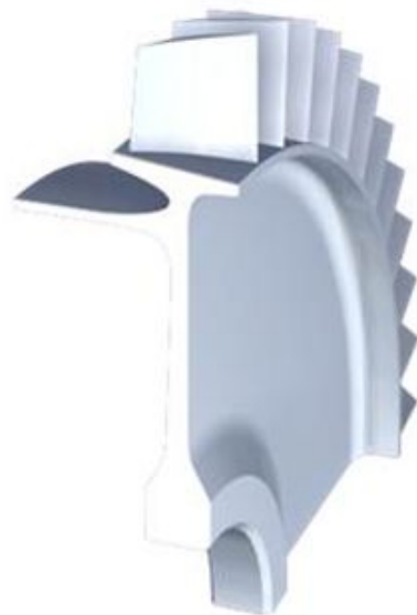
Диск компрессора типа «Блиск» – снижение веса конструкции на 30%
