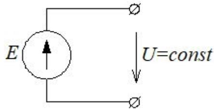
Напряжение на выходе идеального источника ЭДС постоянно и не зависит от нагрузки
