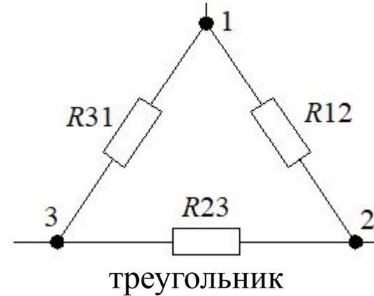
Часто возникает ситуация когда требуется выполнить преобразование из звезды в треугольник и обратно. Для эквивалентного преобразования необходимо равенство проводимостей между соответствующими узлами.
