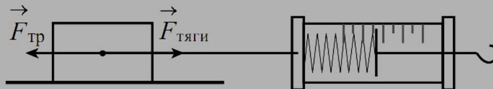
2.  $F_{\text{тяги}} = F_{\text{тр}}$  (при равномерном движении).
