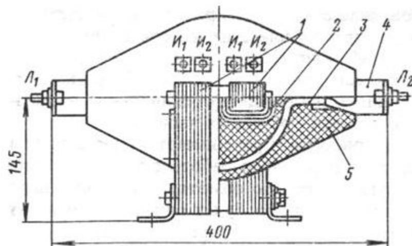
Рисунок 3 -Трансформатор тока ТПЛ-10 с двумя магнитопроводами:
