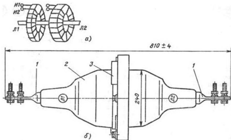
Рисунок 2 -Трансформатор тока ТПОЛ-20:
