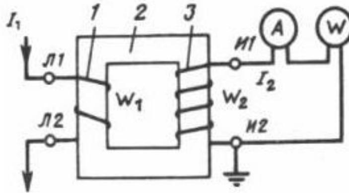
Рисунок 1 - трансформатор тока
