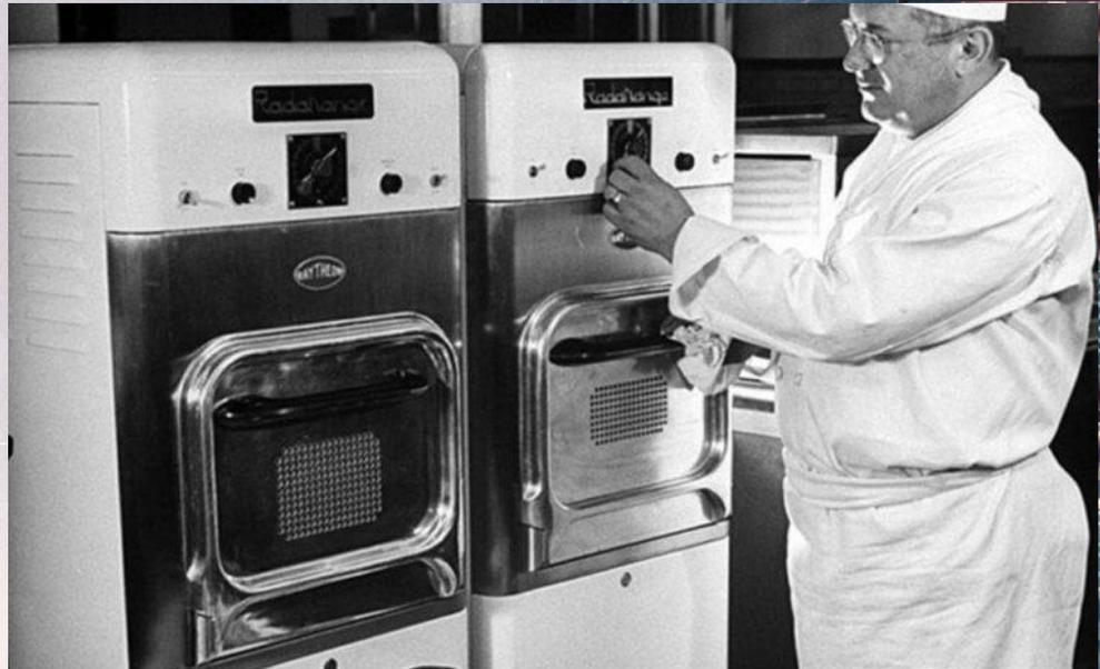
Ее высота составляла 168 сантиметров, масса — 340 кг, а мощность — 3 кВт, что примерно в два раза больше мощности современных бытовых СВЧ-печей.
