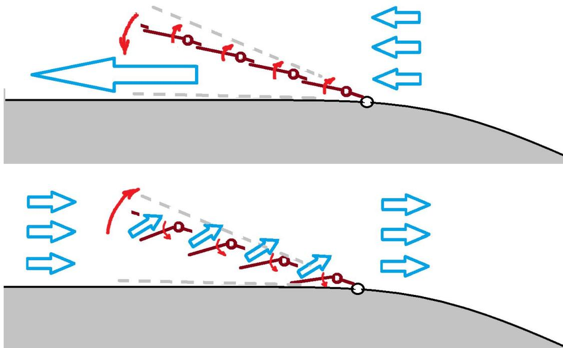
Модель комбинированного движителя в виде плавников с клапанами
