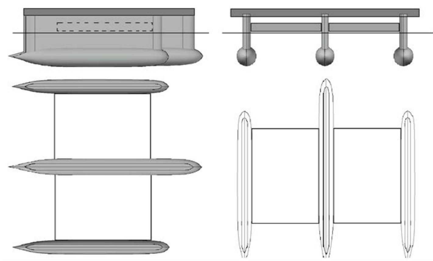
В связи с задержкой изготовления подводных корпусов для проведения первых опытов была изготовлена упрощённая модель судна в виде катамарана
