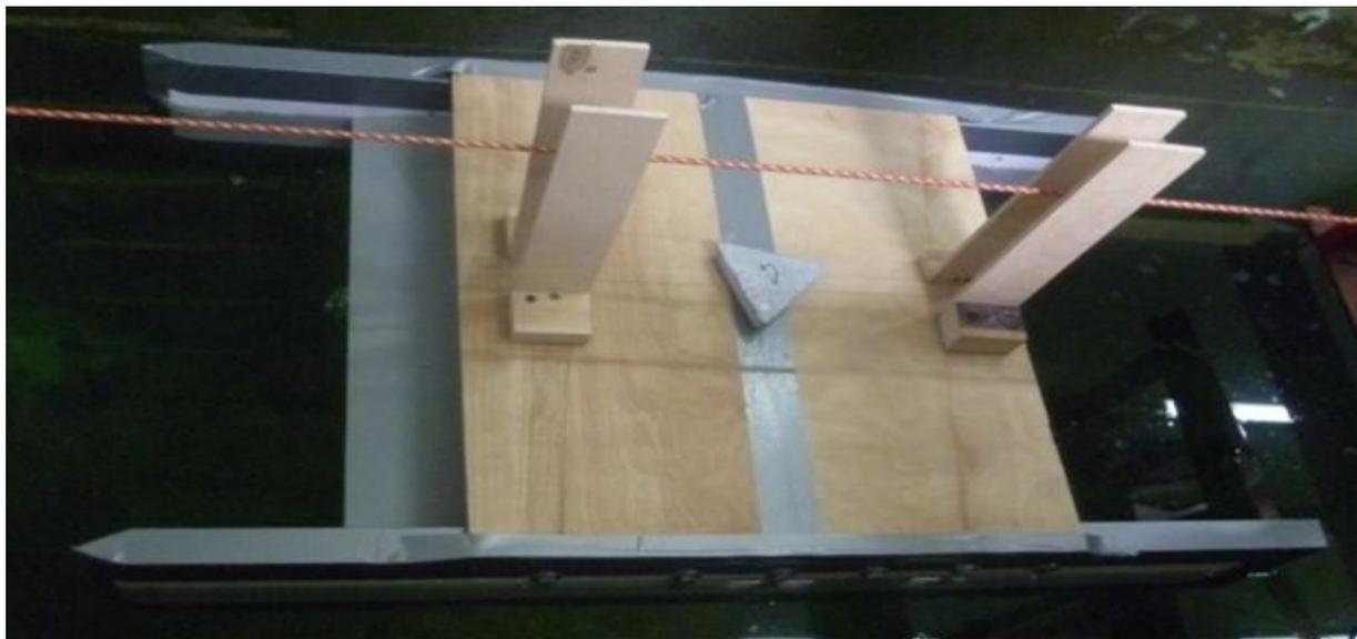
Модель двухкорпусного судна (вид сверху)
