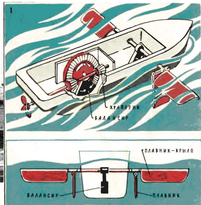
Модель судна с волновым движителем П.Б.Грабовского
