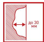
Конструкционный ремонт до 30 мм
