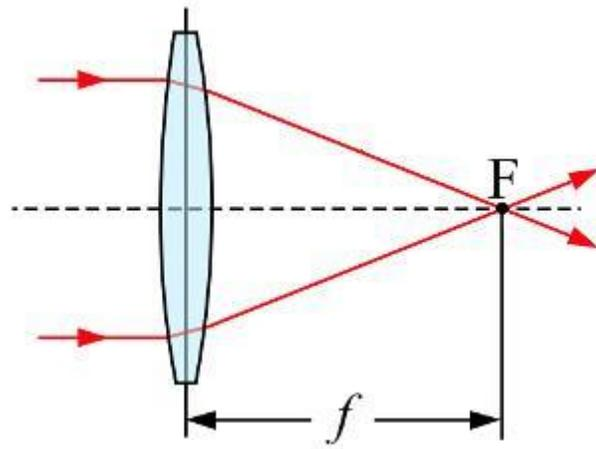
Это расстояние от его оптического центра, до матрицы, на которую проецируется изображение
