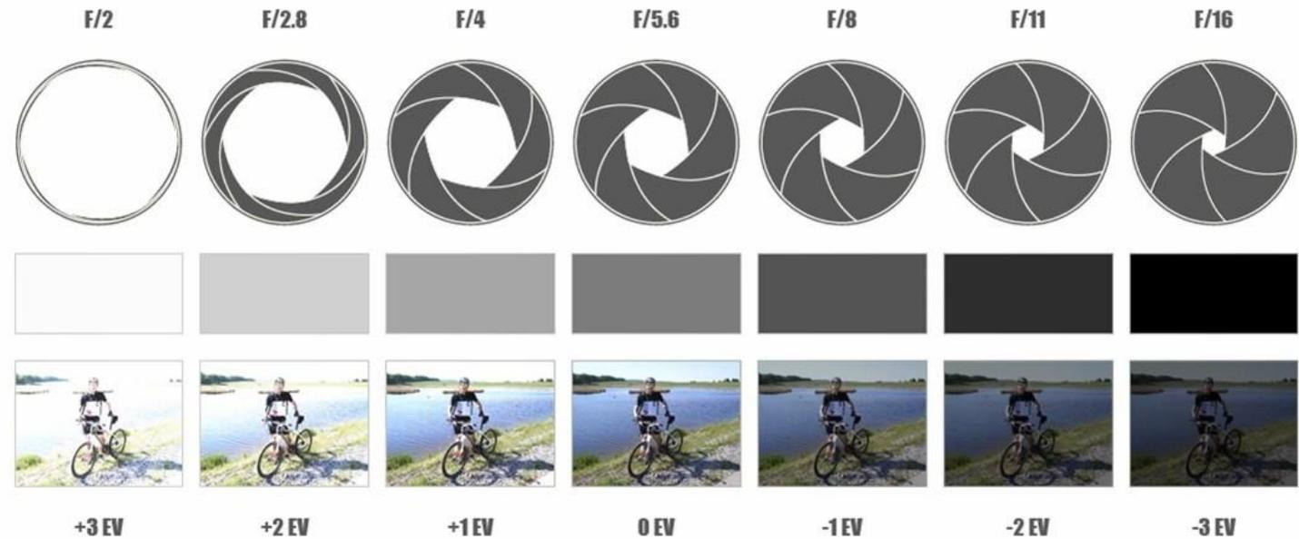
Диафрагма служит для управления интенсивностью светового потока, проходящего через объектив.
