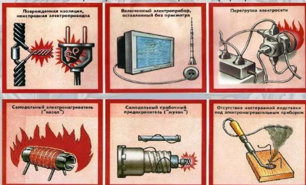
Основными аварийными режимами в электросетях, приводящими к пожару, являются:
