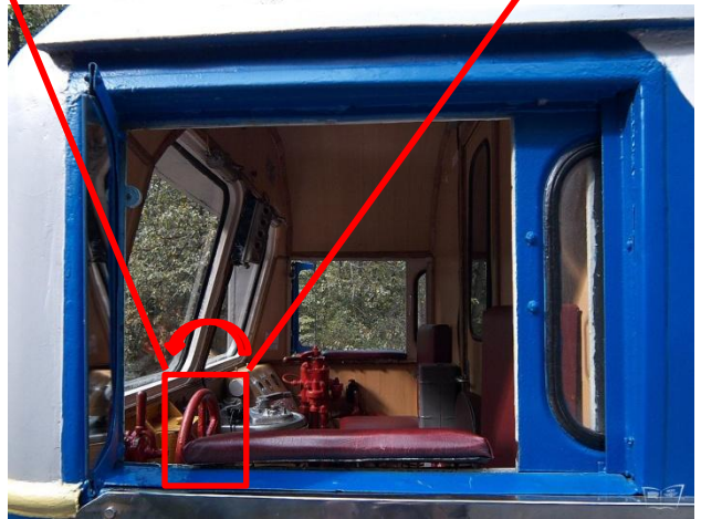
Расположение ручного тормоза на тепловозе ТУ2
