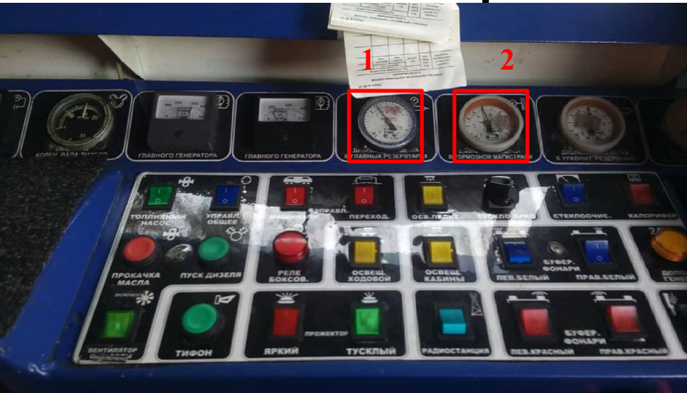
Расположение манометров напорной (1) и тормозной (2) магистралей в кабине ТУ2
