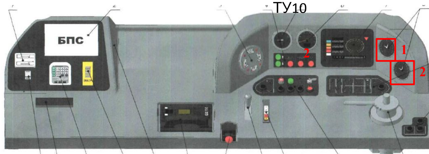
Расположение манометров напорной (1) и тормозной (2) магистралей в кабине ТУ2
