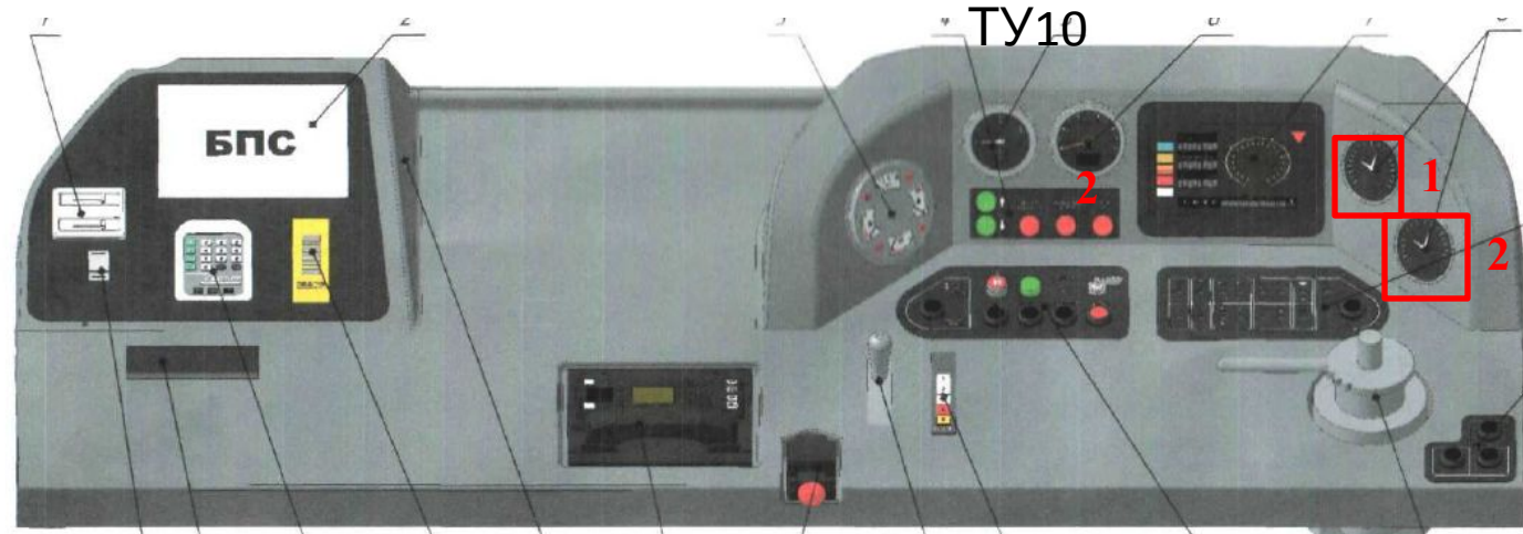
Расположение манометров напорной (1) и тормозной (2) магистралей в кабине ТУ2
