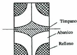
Figura 4.35 Vista en planta de un tramo de bóveda de abanico
