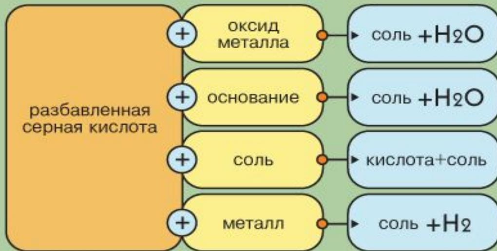
Важнейшее соединение серы — серная кислота. Это соединение проявляет свойства, характерные для любых сильных кислот: реагирует с основными и амфотерными оксидами и гидроксидами, а также солями, если в результате образуется осадок или газ. Разбавленная серная кислота взаимодействует с активными металлами с выделением водорода, а концентрированная — и с малоактивными металлами, обычно при этом образуется оксид серы.
