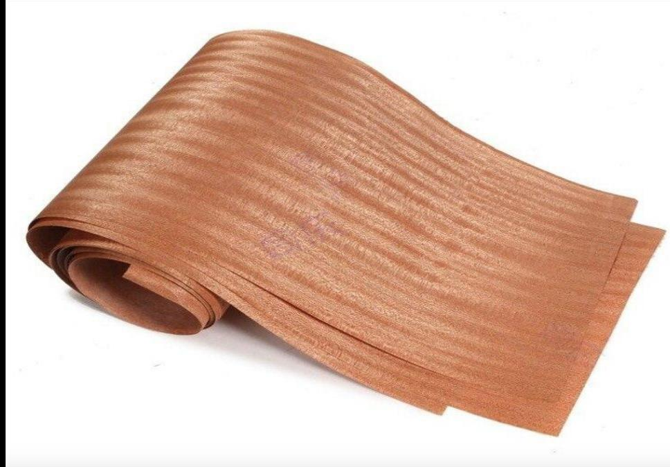
Третий – тангенциальный шпон. На нём годовые слои расположены в виде наклонных конусов или кривых линий, как и сердцевинные лучи. И четвёртый – это торцово-тангенциальный шпон. На его поверхности годовые слои видны как кривые линии, образующие замкнутые фигуры, сердцевинные лучи формируют штрихи или неровные линии.
