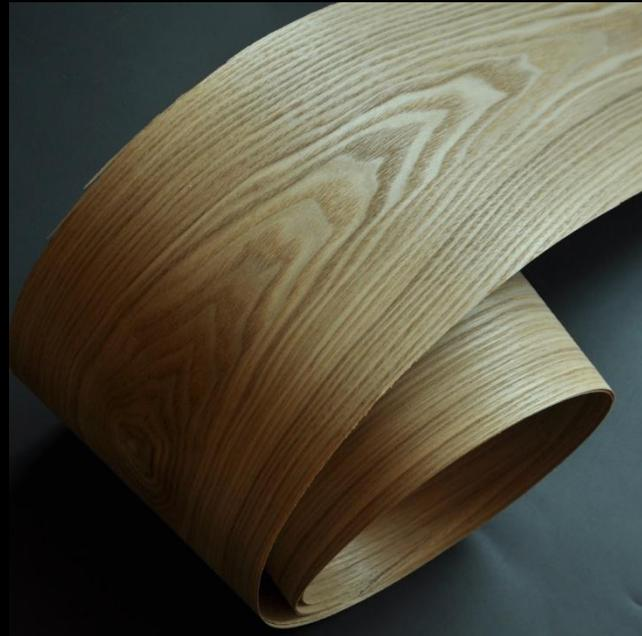
*Строганный шпон* – тонкий слой древесины заданной толщины в виде листа, полученный при строгании бруса или ванчеса на специальных шпонострогальных станках по ГОСТ 2977-82 «Шпон строганный. Тип использования на строганный шпон всегда, но из-за дефицитности этой хвойной породы ее применяют в небольших количества.
