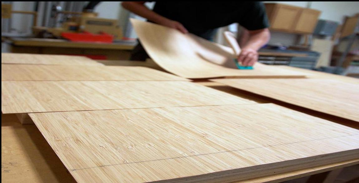
первый из них – это радиальный шпон. Годовые слои ствола дерева выглядят на нём как параллельно расположенные продольные линии. Сердцевинные лучи – в виде полос неодинаковой ширины. Второй вид строганного шпона – это полурадialный. Годовые слои видны на большей части поверхности листа, сердцевинные лучи выглядят как полосы, расположенные наклонно или продольно.
