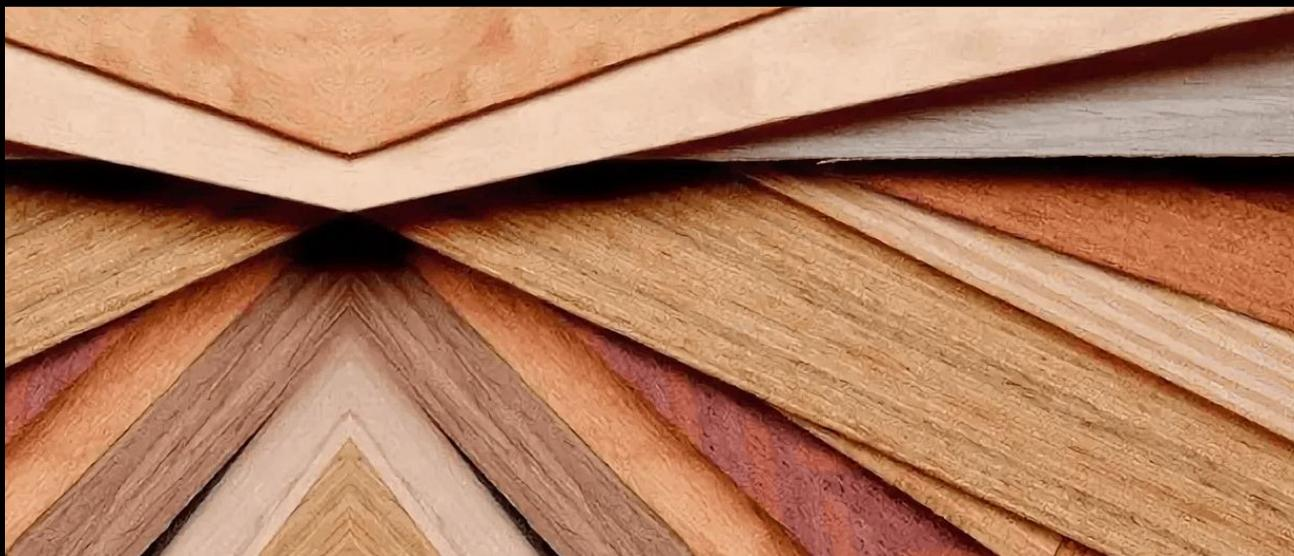
Шпон строганный используется в качестве облицовочного материала для изделий из древесины и древесных плит. Листы при этом подбирают по текстуре, цвету, породе в рубашки разной ширины с целью получения высокого качества полуфабрикатов, деталей и изделий мебели, элементов интерьера, строительных конструкций.
