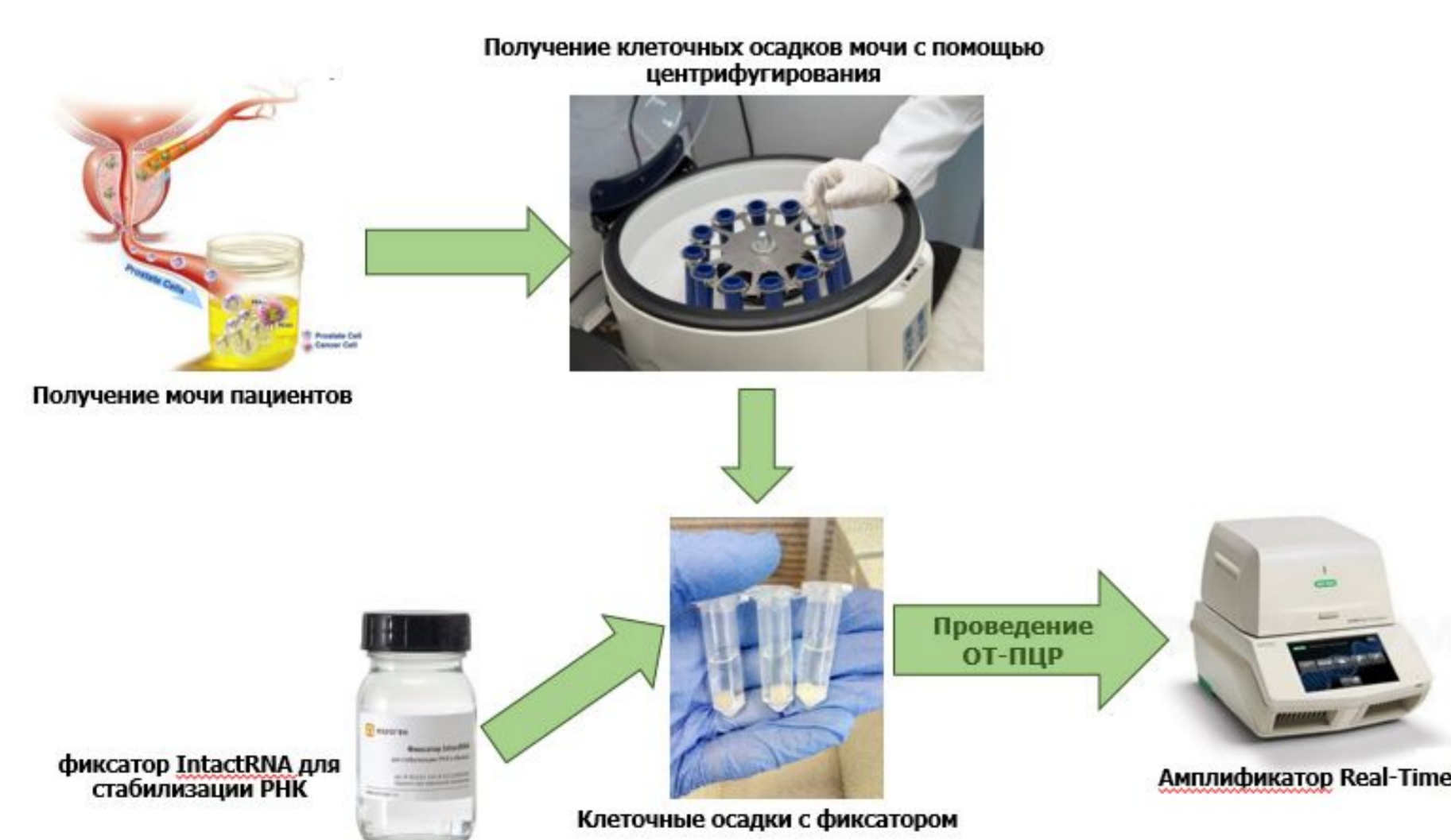
Рис. 1. Схема проведения исследования экспрессии химерного гена в моче пациентов.
