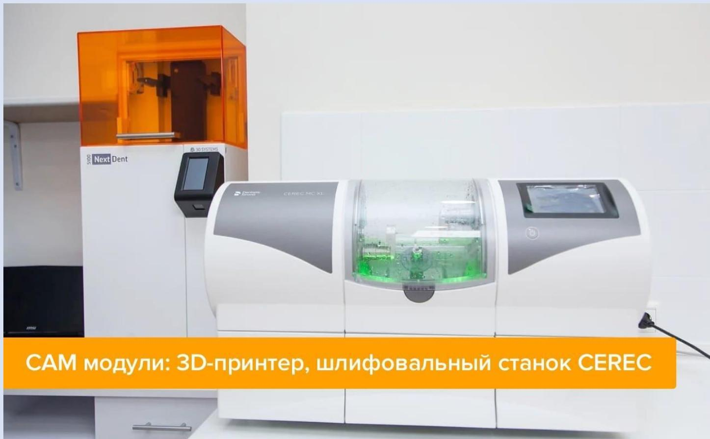
САМ модули: 3D-принтер, шлифовальный станок CEREC
