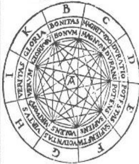
Луллий создал приспособление в виде бумажных кругов разного диаметра, нанизанных на общий стержень (по типу пирамидки). В верхней части стержня устанавливается стрелка. Круги подвижны. Все они разделены на одинаковое количество секторов.
