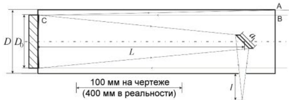
! Вначале начертим трубу в масштабе 1:4. Затем с одного из ее концов нарисуем зеркало так, чтобы его центр его оптической поверхности пришелся на центр задней стенки трубы. Сделаем вспомогательное построение — нарисуем главную оптическую ось зеркала, совпадающую с осью трубы. Вычислим, на каком расстоянии от главного зеркала должен находиться центр вторичного зеркала. Для этого из фокусного расстояния  $F$  вычтем вынос фокуса  $l$  и радиус трубы  $D/2$ . Получим:
