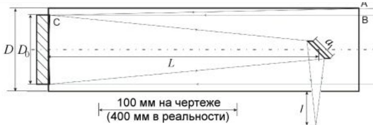
Вычислим масштаб изображения. Угловому расстоянию в  $1^\circ$  ( $1/57.3$  радиан) будет соответствовать линейный размер  $d$  в фокальной плоскости. Он зависит только от фокусного расстояния телескопа и равен
