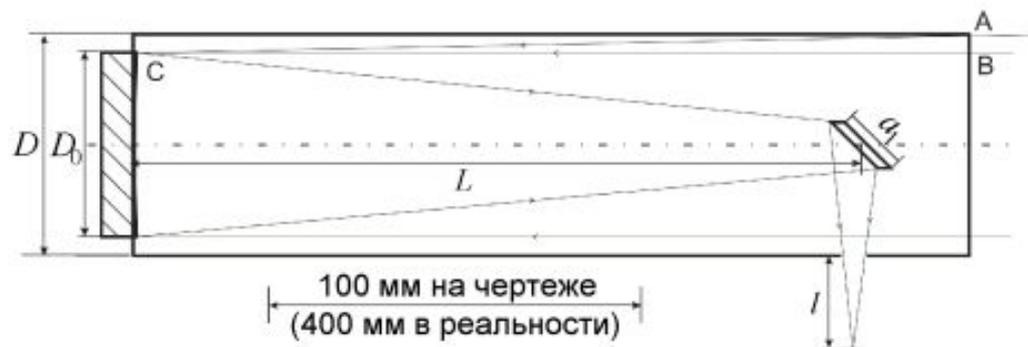
**!** Вначале начертим трубу в масштабе 1:4. Затем с одного из ее концов нарисуем зеркало так, чтобы его центр его оптической поверхности пришелся на центр задней стенки трубы. Сделаем вспомогательное построение — нарисуем главную оптическую ось зеркала, совпадающую с осью трубы. Вычислим, на каком расстоянии от главного зеркала должен находиться центр вторичного зеркала. Для этого из фокусного расстояния  $F$  вычтем вынос фокуса  $l$  и радиус трубы  $D/2$ . Получим:
