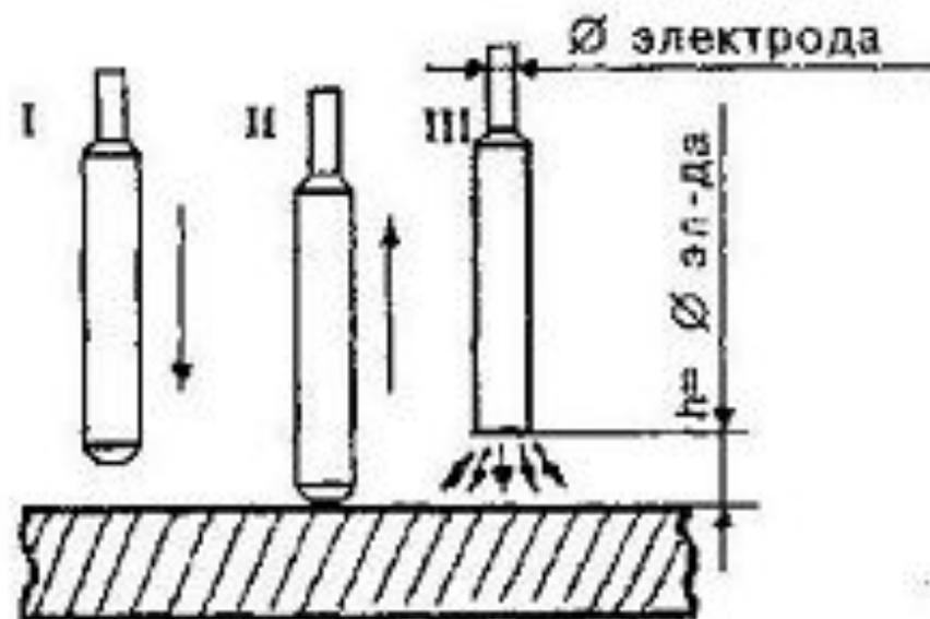
*Такой способ зажигания дуги легко применять электродами с качественно изготовленными торцами.*
