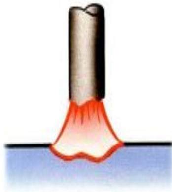
Образование прослойки из жидкого металла
