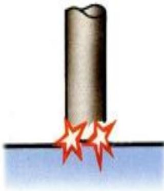
Образование прослойки из жидкого металла
