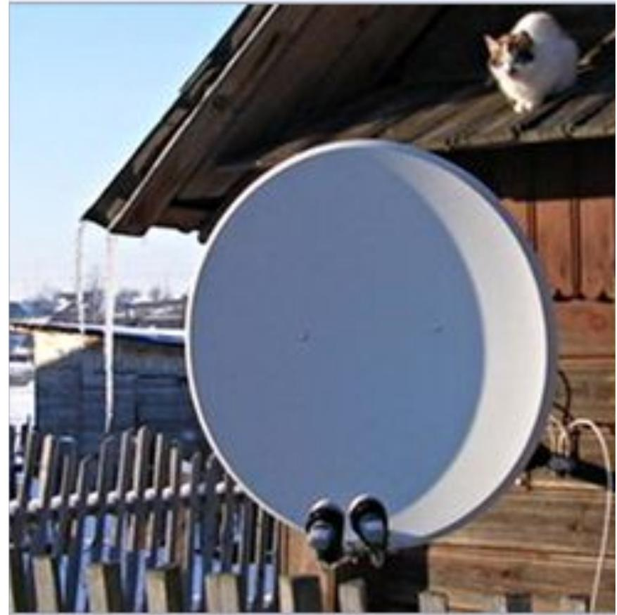
Спутниковая тарелка – это параболическое зеркало, в фокусе которого расположено приёмное устройство (конвертер).
