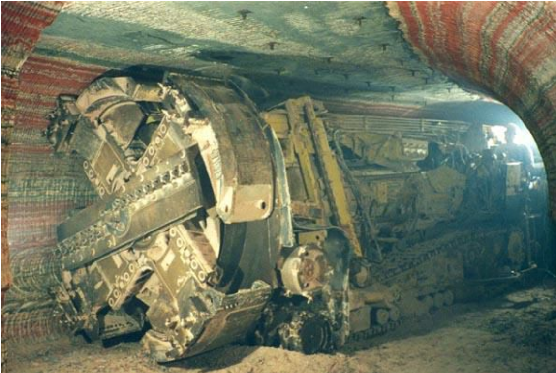
Рисунок 1.5 – Проходческий комбайн с соосными роторами в подземной горной выработке месторождения калийных солей
