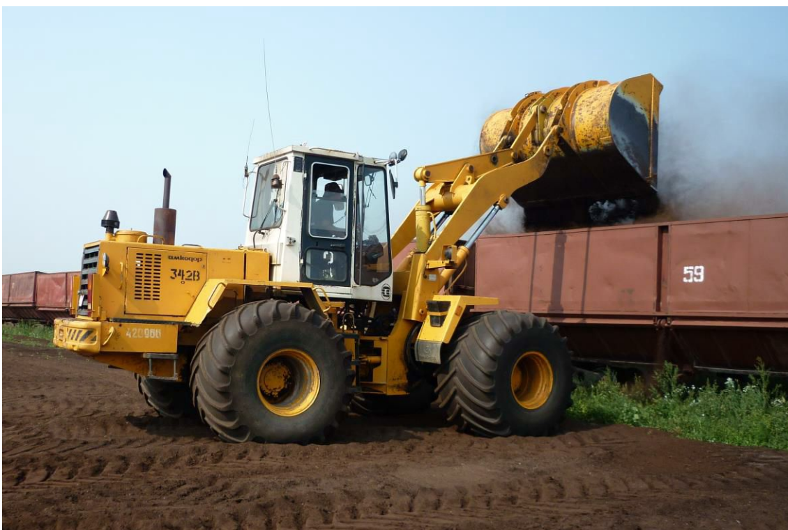
Рисунок 1.3 - Погрузка фрезерного торфа в вагоны железнодорожного состава узкой колеи
