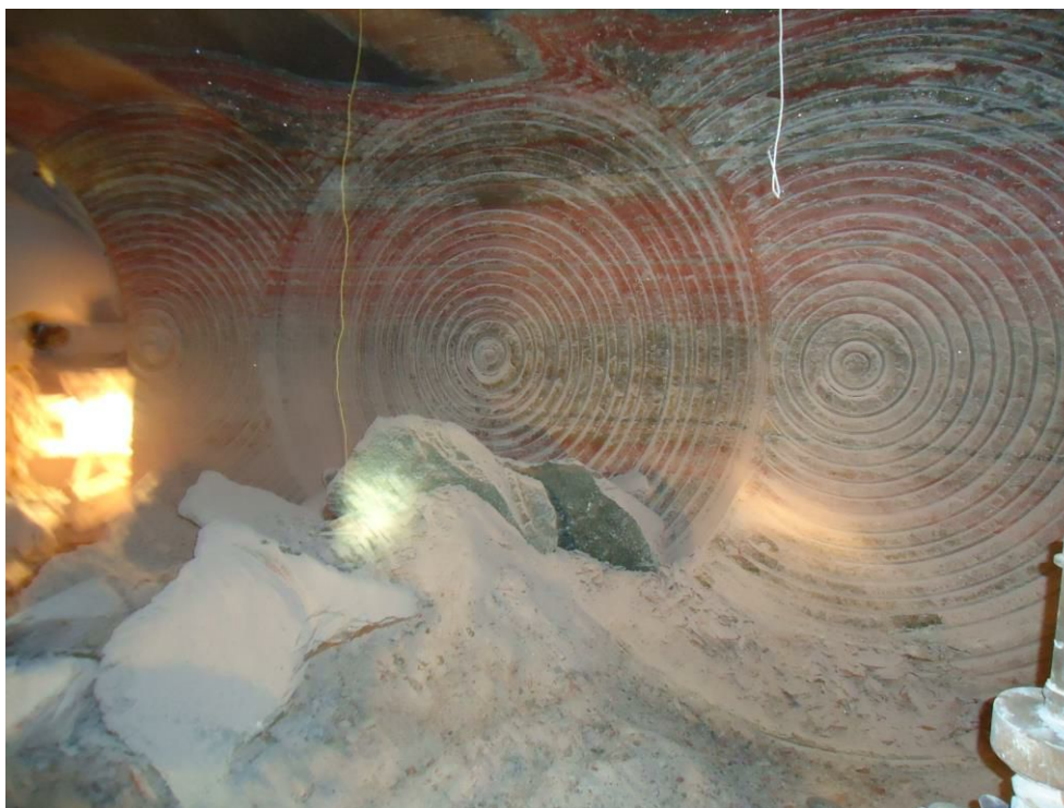
Рисунок 2.13,а – Форма забоя при фрезеровании разрабатываемого пласта соосными роторами (три косых захода комбайна ПКС-8)
