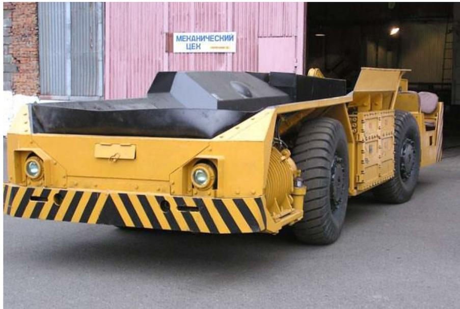
Рисунок 4.14 - Вагон самоходный 5BC15М (схема «кран»)
