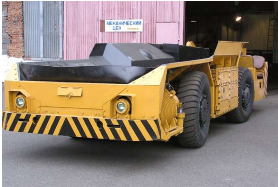
Рисунок 4.14 - Вагон самоходный 5BC15М (схема «кран»)
