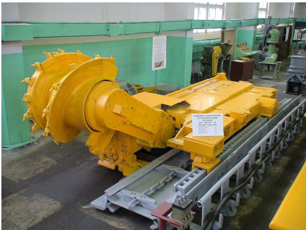
Рисунок 4.28 – Одношнековый очистной комбайн
