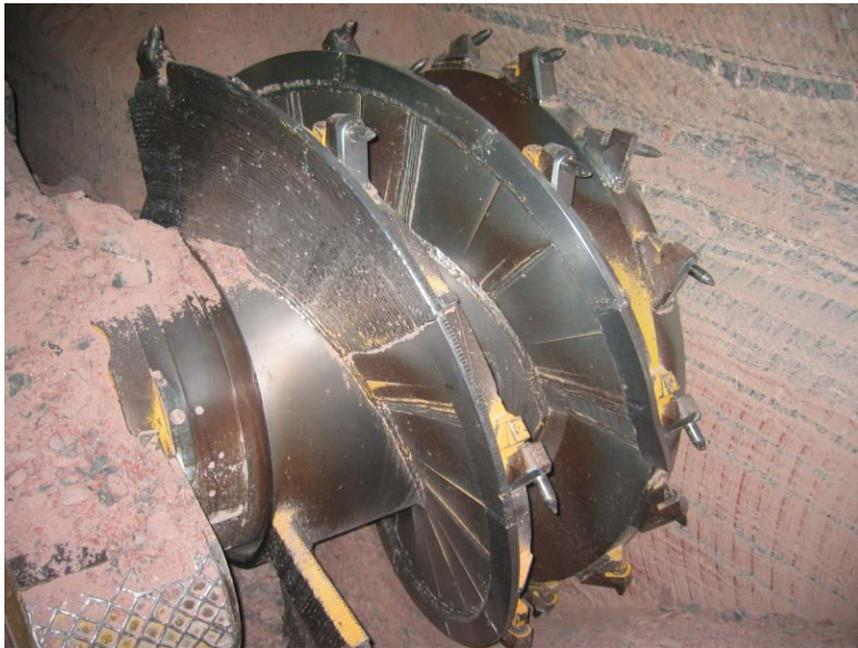
Рисунок 2.8 – Шнек-фреза очистного комбайна
