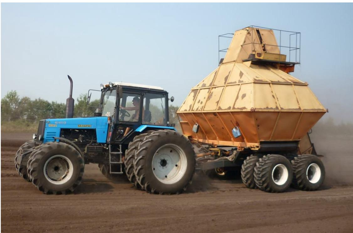
Рисунок 1.2 – Уборочный машинно-тракторный агрегат на технологической площадке разрабатываемого торфяного месторождения
