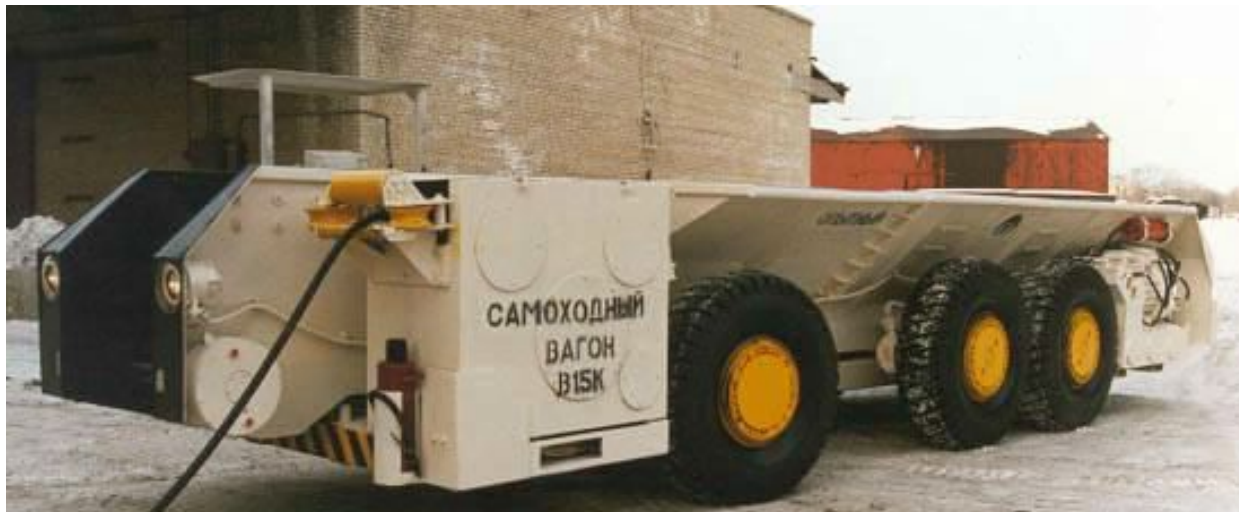
Рисунок 4.15 - Самоходный вагон В15К (схема 6x3)
