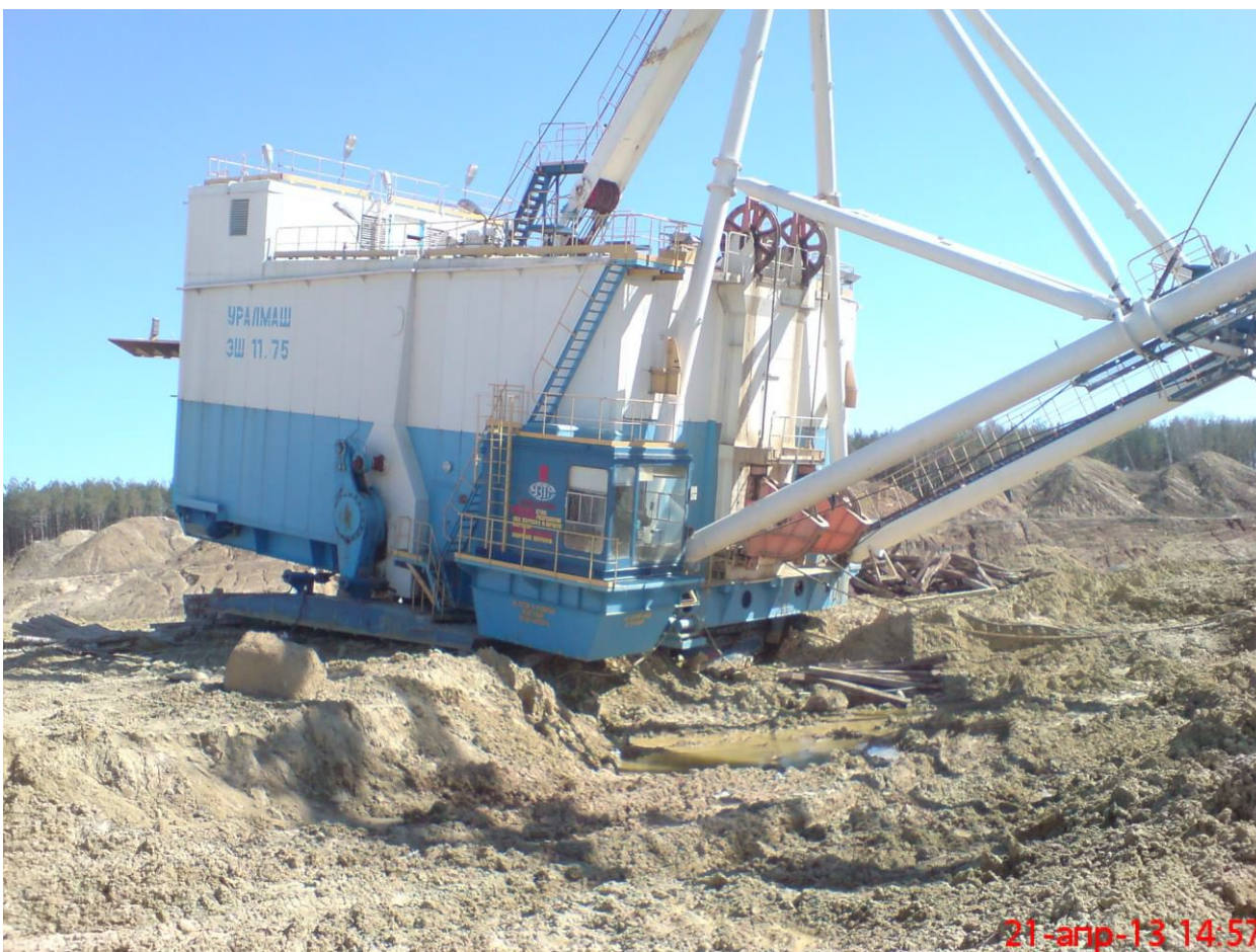
Рис. 1.6,б – Крен шагающего экскаватора на откосе мелового карьера в период весенней распутицы
