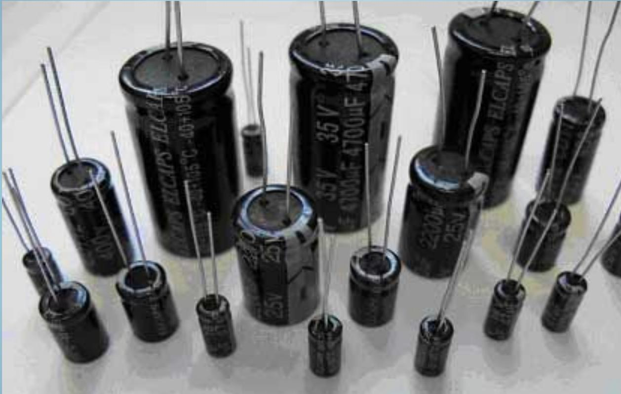
В качестве диэлектрика используют электролиты,
