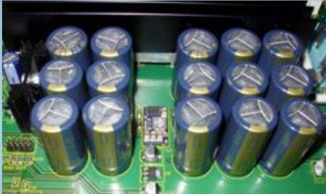
Изготавливается из двух лент фольги (оксидированной и неоксидированной), между которыми размещается прокладка из бумаги или ткани, пропитанной электролитом. Фольга сворачивается в рулон и помещается в кожух. Выводы делаются от оксидированной фольги (анод) и не оксидированной (катод).
