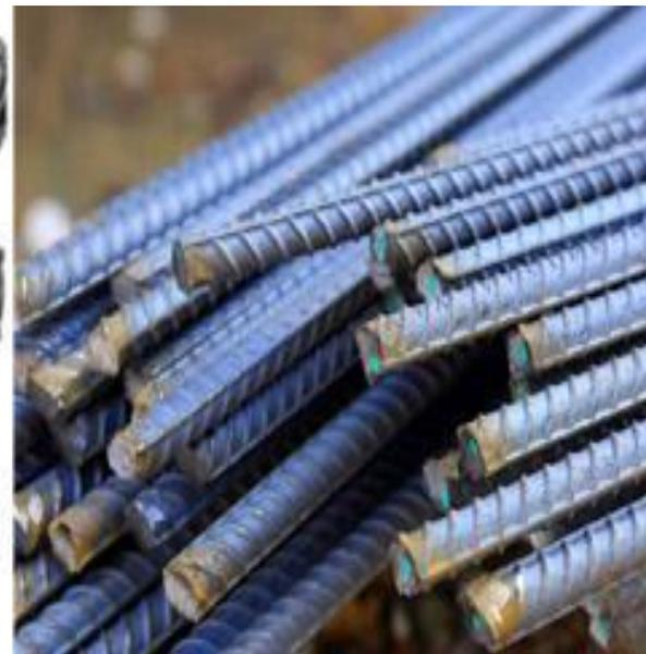
Арматура периодического профиля представляет собой круглые профили с двумя продольными и поперечными выступами.
