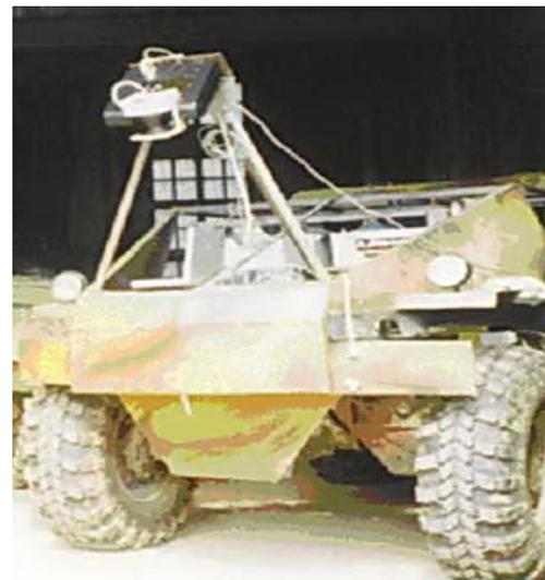
**Обеспечивается телеуправление роботизированной машиной со скоростью движения до 20 км/ч оператором, находящимся на удалении до 2км**
