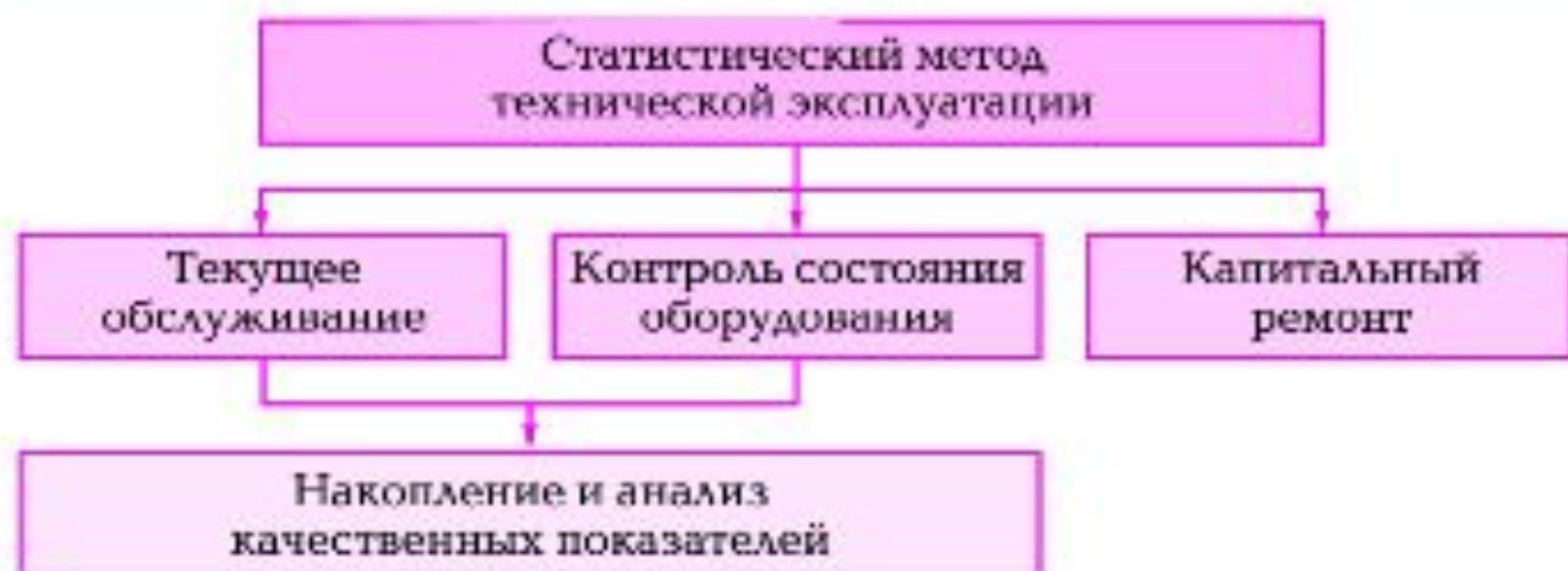
Рис. 2.1. Структура контрольно-корректирующего метода ТО
