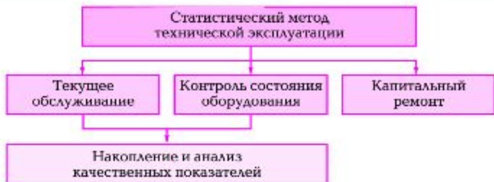
Рис. 2.1. Структура контрольно-корректирующего метода ТО
