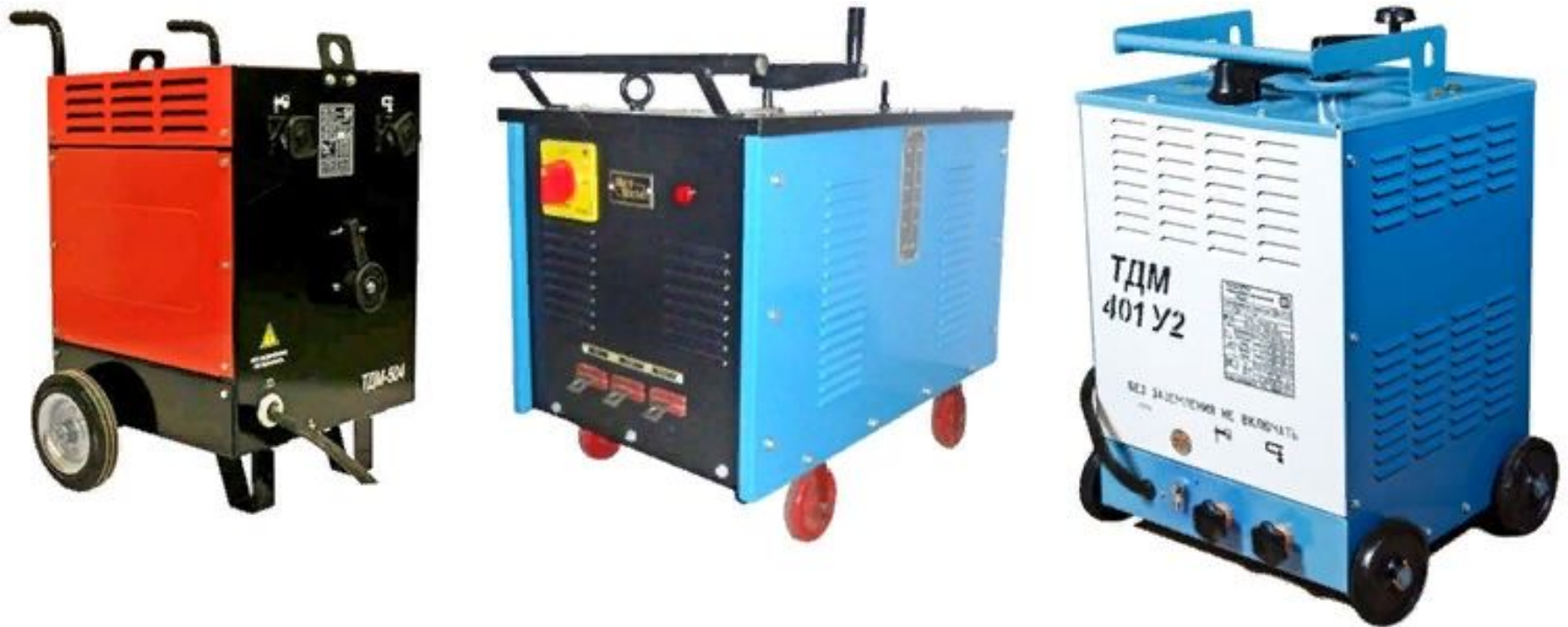
Внешний вид сварочных трансформаторов
